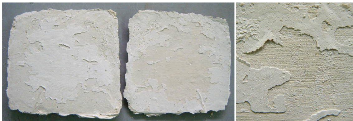
Figura III.25. Plaquetas de cascarilla cerámica separadas con escayola.
