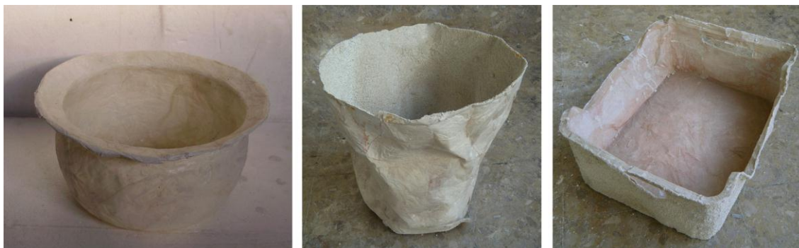
Figura III.30. De izquierda a derecha: papel de seda, papilla aplicada en el interior de soporte (papel sólo), papilla aplicada exteriormente (papel sólo).
