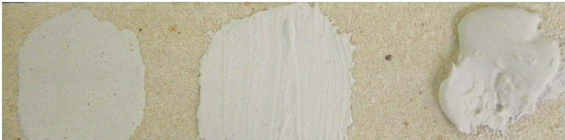
Figura. III.76. Aplicación de las tres composiciones de papilla sobre plaquetas de cascarilla cerámica cocidas a 1000°C.
