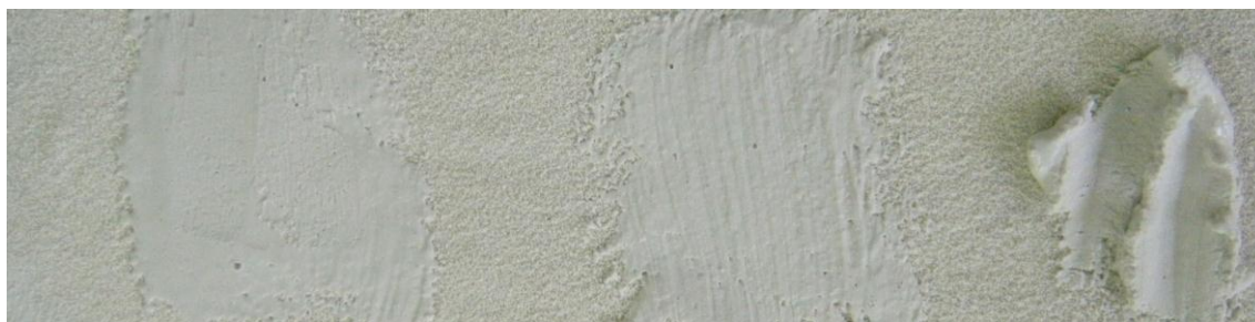
Figura. III.73. Aplicación de las tres composiciones de papilla sobre plaquetas de cascarilla cerámica en crudo.
