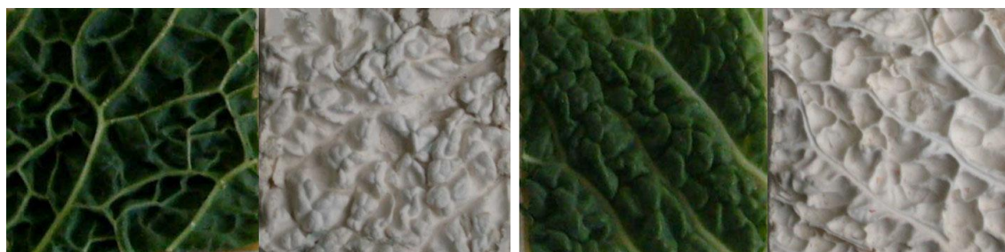
Figura III.34. Anverso y reverso de hoja de col (soporte flexible) y su reproducción en cascarilla cerámica.
