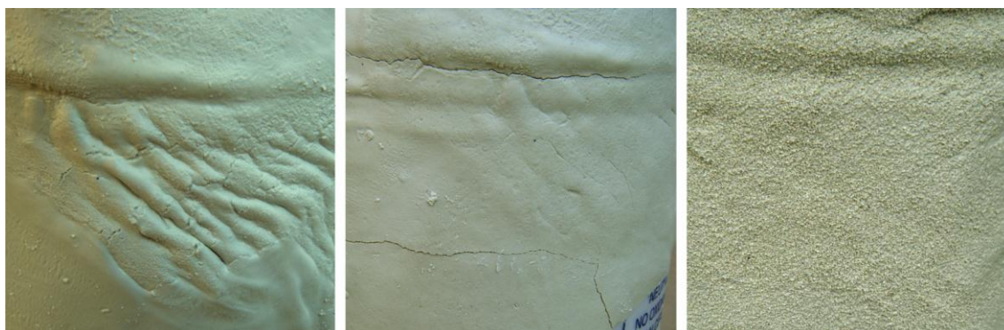
Figura III.65. Papilla arrugada (izquierda) papilla agrietada (centro) papilla con rebozado (derecha).
