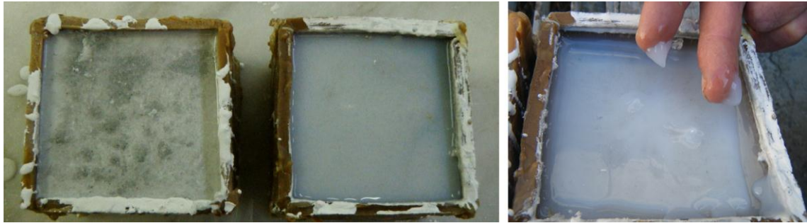
Figura III.62. Tres fases de la papilla en el cubo: papilla en fase estabilización (izquierda), fase de separación de la sílice con la Moloquita (centro), gelificación de la sílice (derecha).
