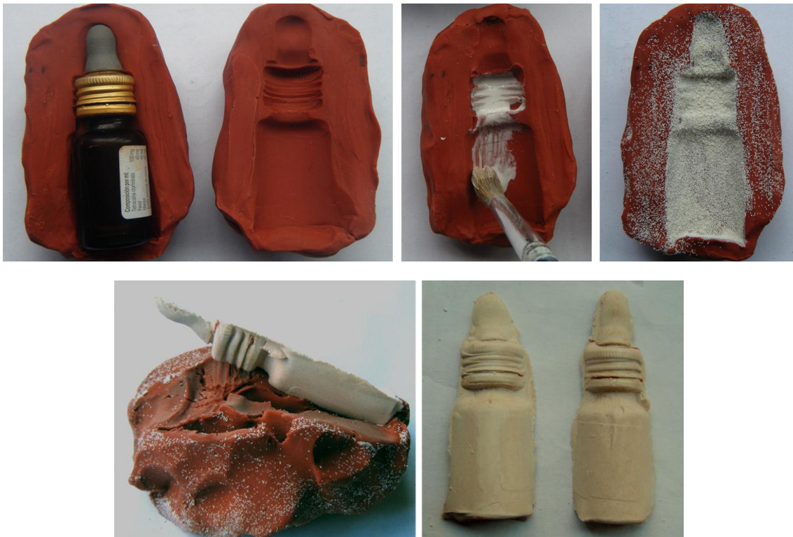
Figura III.52. Procedimiento de elaboración de una pieza de cascarilla cerámica mediante molde de plastilina.
