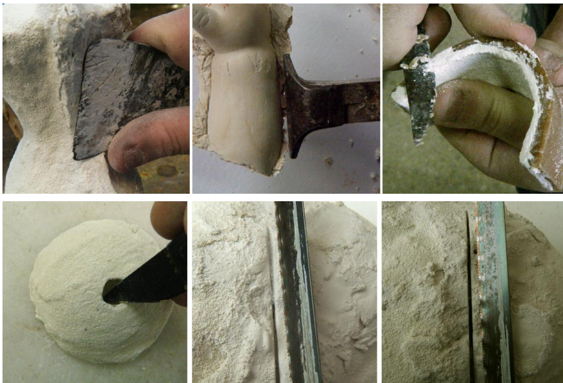
Figura III.85. Utilización de herramientas en la modificación de la superficie de la cascarilla cerámica, espátula, sierra para metal, tenazas, cuchillo.
