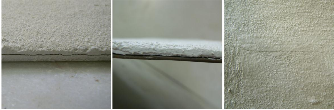
Figura III.22. De izquierda a derecha: Plancha de poliestireno con cascarilla cerámica, plancha de hierro recubierta de cinta de embalaje, grieta en la superficie de la cascarilla cerámica provocada por la flexibilidad del soporte.
