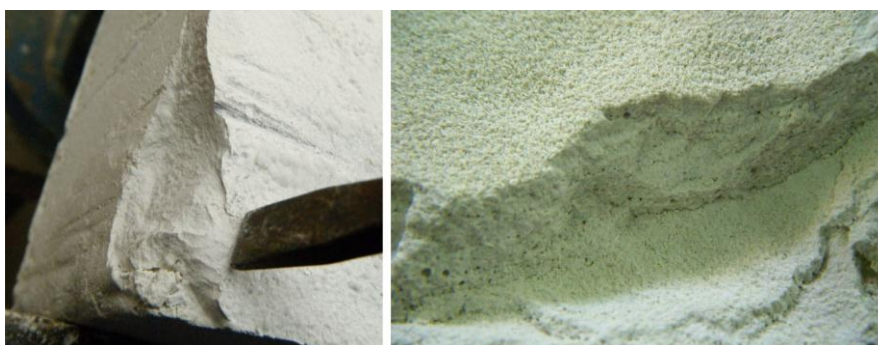
Figura III.79. Rotura de los bloques mediante cincel: bloque sólo papilla (izquierda); bloque realizado por capas de papilla y rebozado (derecha).
