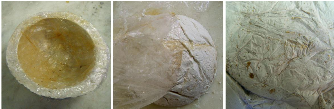
Figura III.23. De izquierda a derecha: Molde de escayola recubierto de film de plástico, desmoldeado, arrugas del aislante reproducidas en la superficie de la cascarilla cerámica.
