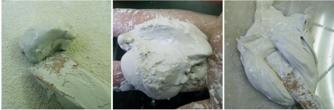
Figura III.10. Resultados de proceso de amasado de los tres tipos de empaste: PW 50 30/70% (izquierda), Hispasil 1731 30/70% (centro), Carsil 9 40/60% (derecha).
