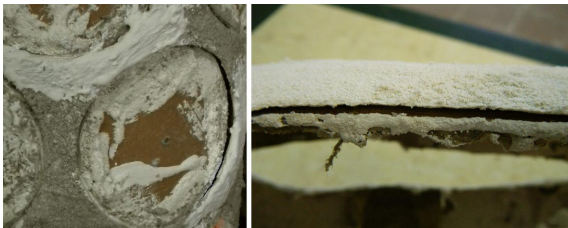
Figura. III.17. Separación de la cascarilla cerámica y el cartón sin utilizar desmoldeante.
