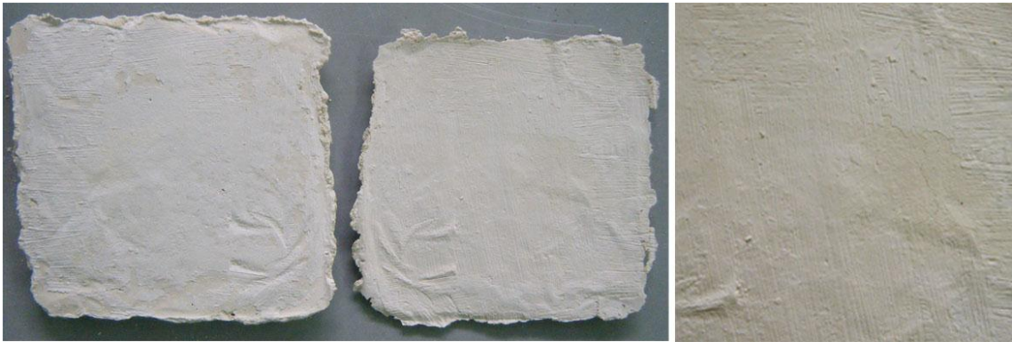
Figura III.26. Plaquetas de cascarilla cerámica separadas mediante un estratificado de goma laca, escayola y goma laca.
