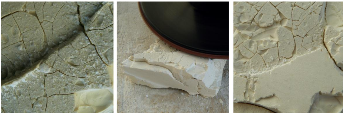
Figura III.84. Desbaste de la superficie de la cascarilla cerámica cocida a 1200 °C mediante disco de carbono.
