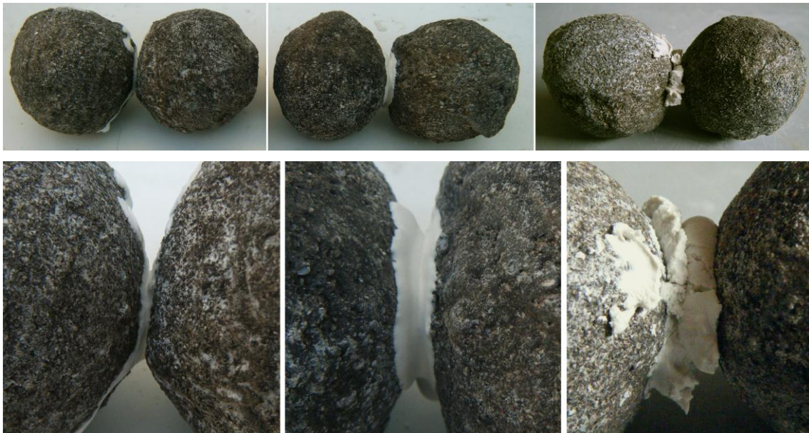
Figura III.88. Esferas unidas con papilla de composición 40/60% (izquierda), esferas unidas con papilla 35/65% (centro) y esferas unidas con papilla 30/70% (derecha)
