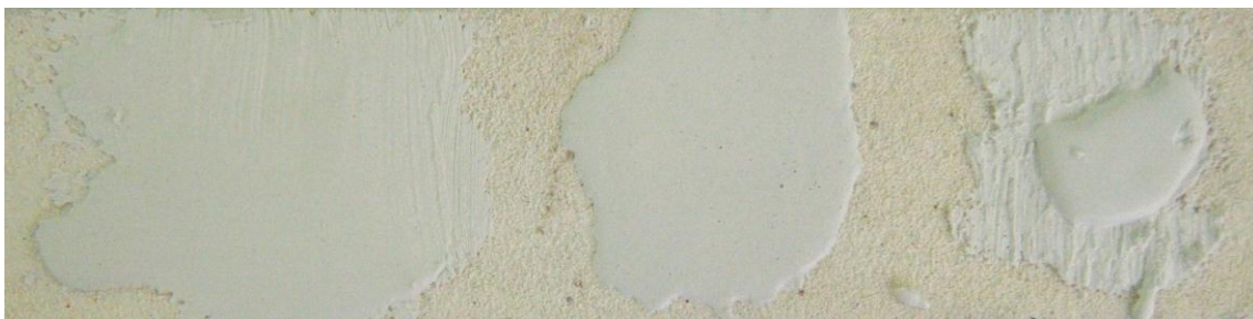
Figura. III.77. Aplicación de las tres composiciones de papilla sobre plaquetas de cascarilla cerámica cocidas a 1200°C.
