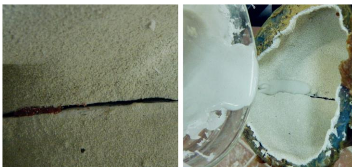
Figura III.48. Izquierda: aplicación de la plastilina en la hendidura del molde. Derecha: aplicación de la papilla en la hendidura.
