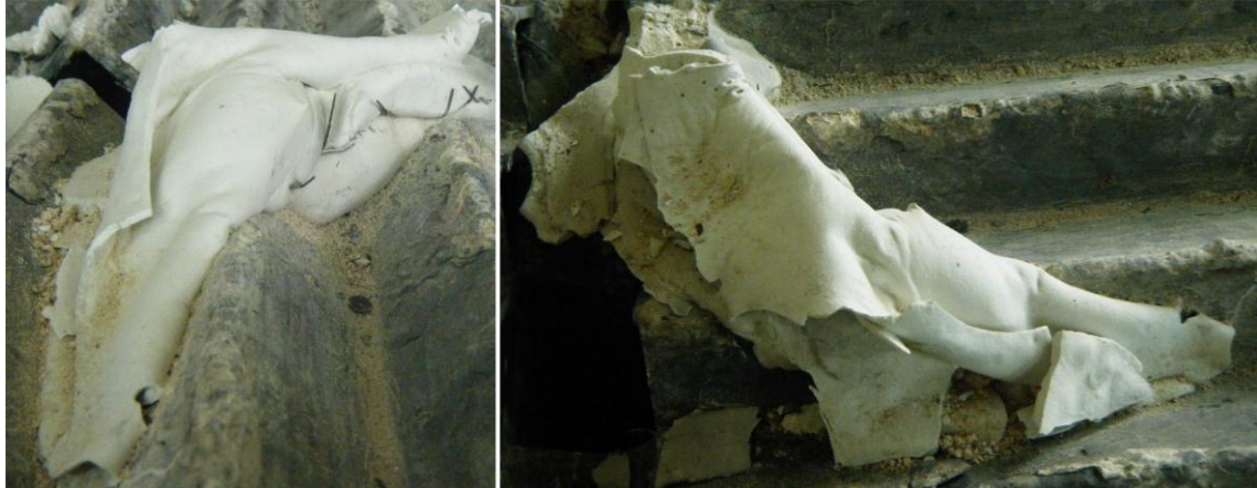
Figura. III.12. Deformación tras la cocción de la plancha de cascarilla cerámica hecha con Carsil 9.
