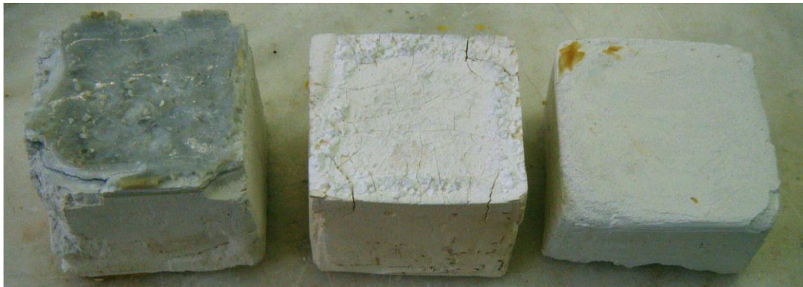
Figura III.63. Los dos bloques conformados de papilla (izquierda y centro) bloque conformado por capas (derecha).
