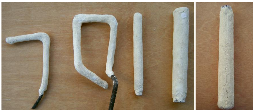
Figura III.67. Varilla corrugada recubierta de cascarilla cerámica. Derecha: Detalle de varilla de diámetro 20mm con grieta.
