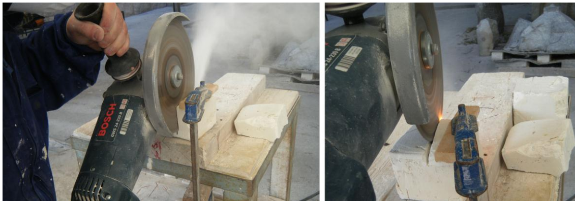
Figura III.80. Corte de bloque de papilla, cocido a 750°C (izquierda); bloque cocido a 875°C (derecha).
