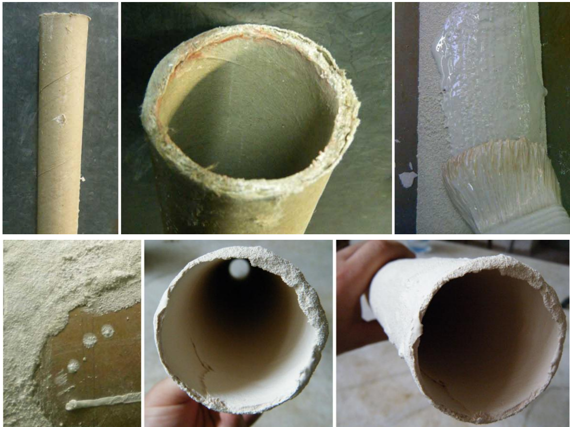
Figura III.31. Aplicación de la cascarilla cerámica sobre tubo de cartón. (Fotos superiores). Resultado después de la cocción, tubo de cascarilla cerámica (fotos inferiores)
