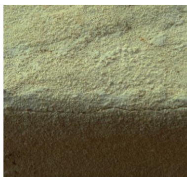
Figura III.29. Fractura de la cascarilla cerámica en Okume.
