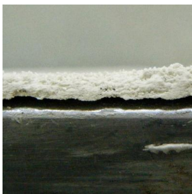
Figura III.7. Separación de la cascarilla cerámica con acero inoxidable ante de la cocción debido al jabón.
