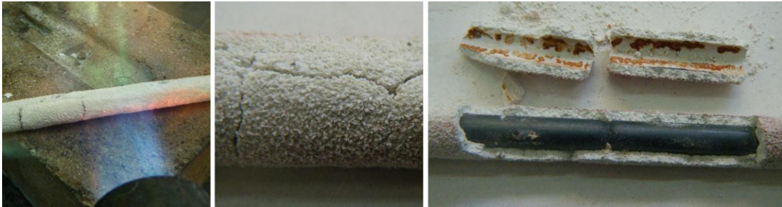
Figura III.68. Varilla lisa cubierta de cascarilla cerámica que se rompe por el calentamiento del soplete.
