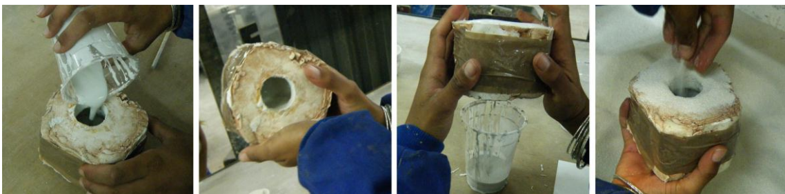
Figura III.56. Procedimiento de vertido.
