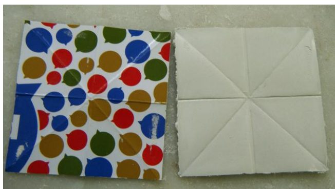
Figura III.18. Papel sin tensoactivo. Antes y después de la aplicación.
