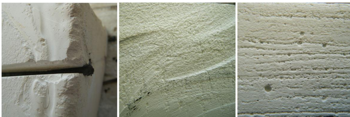
Figura III.81. Bloque macizo de sólo papilla cocido a 875°C (izquierda), textura interior del bloque de sólo papilla cocido a 750°C (centro, textura interior del bloque conformado de capas de papilla y rebozado (derecha).
