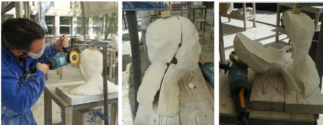
Figura III.82. Operación de corte de la cascarilla cerámica con el empleo de amoladora angular.
