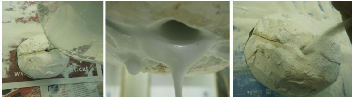
Foto III.44. Vertido de la papilla y rebozado para unir las dos piezas en cascarilla cerámica.
