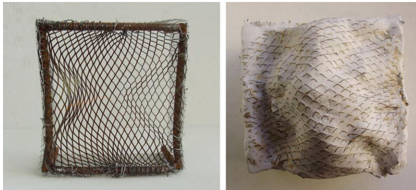
Figura III.71. Antes y después de la aplicación de la papilla sobre la malla metálica.
