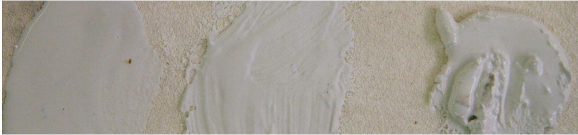
Figura. III.74. Aplicación de las tres composiciones de papilla sobre plaquetas de cascarilla cerámica cocidas a 750°C.
