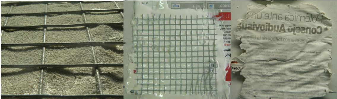
Figura III.70. Izquierda: no hay adherencia de la papilla con la malla. Centro y derecha: imágenes de la unión entre la papilla y la malla a través de papel.
