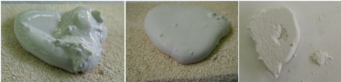
Figura. III.78. Separación de la papilla (30/70%) sobre plaquetas de cascarilla cerámica cruda y cocida a 875°C.
