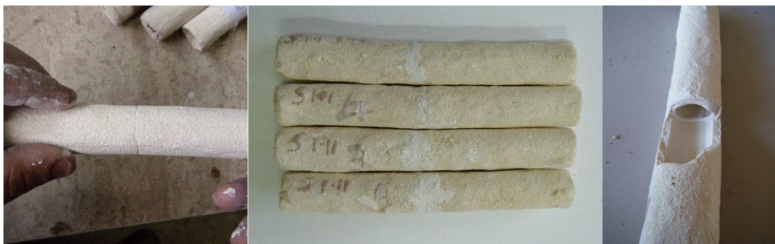
Figura III.90. Procedimiento de preparación de probetas reparadas.
