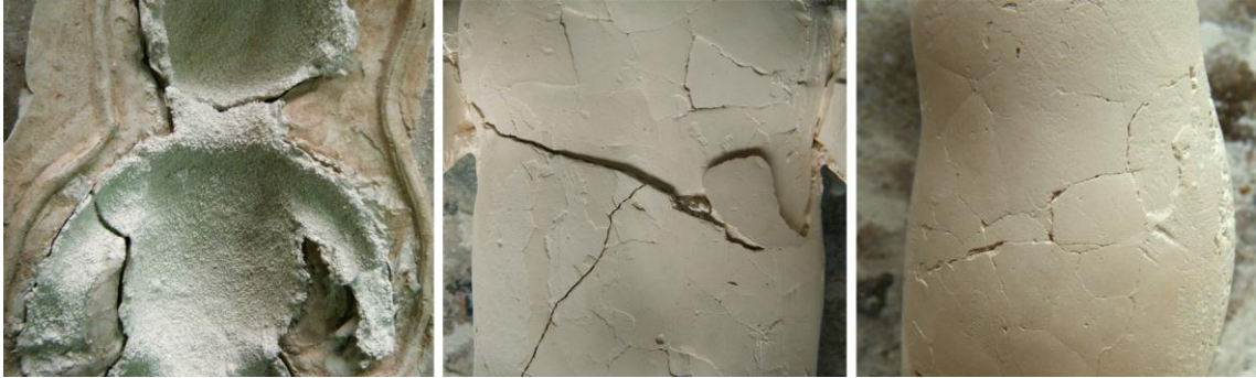
Figura III.55. De izquierda a derecha: Rotura por desmoldeado, rotura por separación de la silicona y la caja madre. (Molde de Clara Sendrera Agullo)
