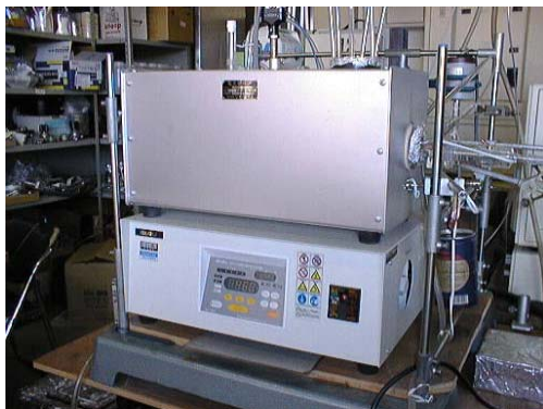
Figura 2.25. Horno tubular utilizado para la calcinación de las membranas preparadas por el método del sol coloidal y hot coating .
