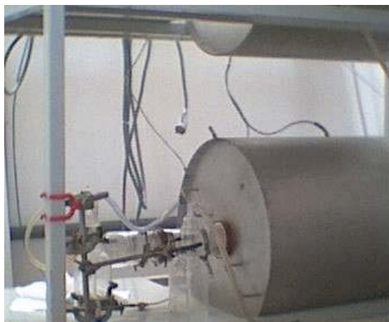
Figura 2.8. Horno tubular utilizado en la calcinación de las membranas preparadas por la ruta del gel polimérico y slip casting .
