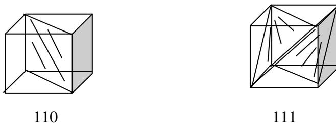
Figura I.3. Planos cristalográficos de la superficie metálica.
