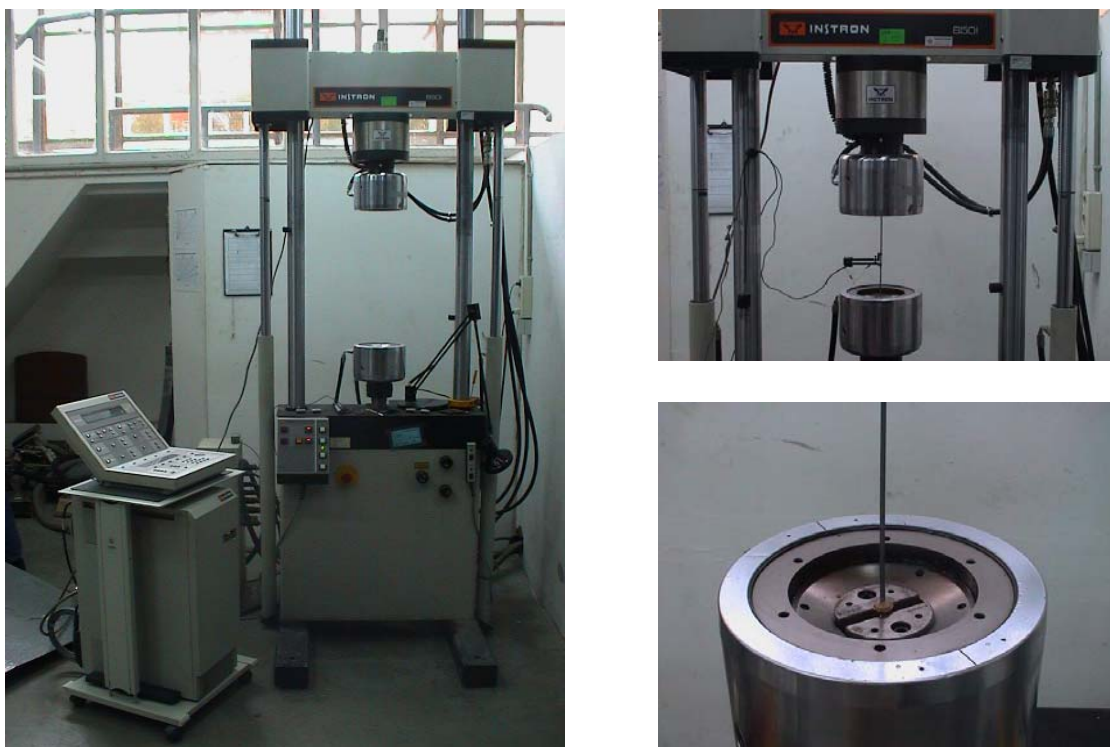
Figura 5-2. Máquina empleada para el ensayo a tracción directa del alambre
