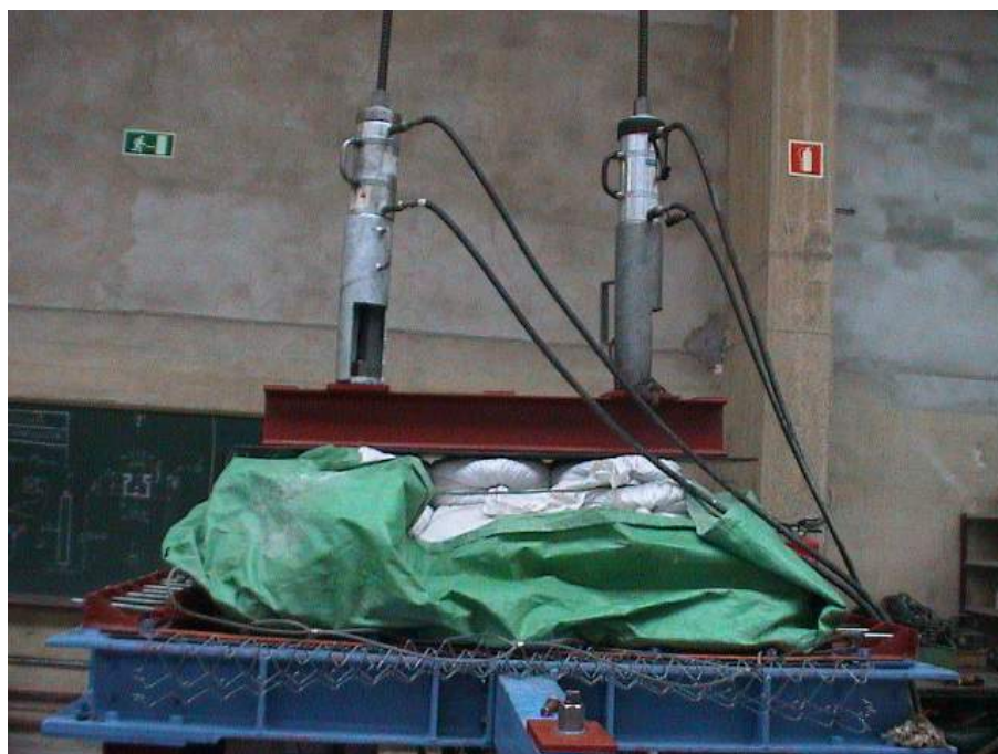
Figura 6-11. Aplicación de la carga en el Ensayo de carga distribuida “Unidireccional”.
