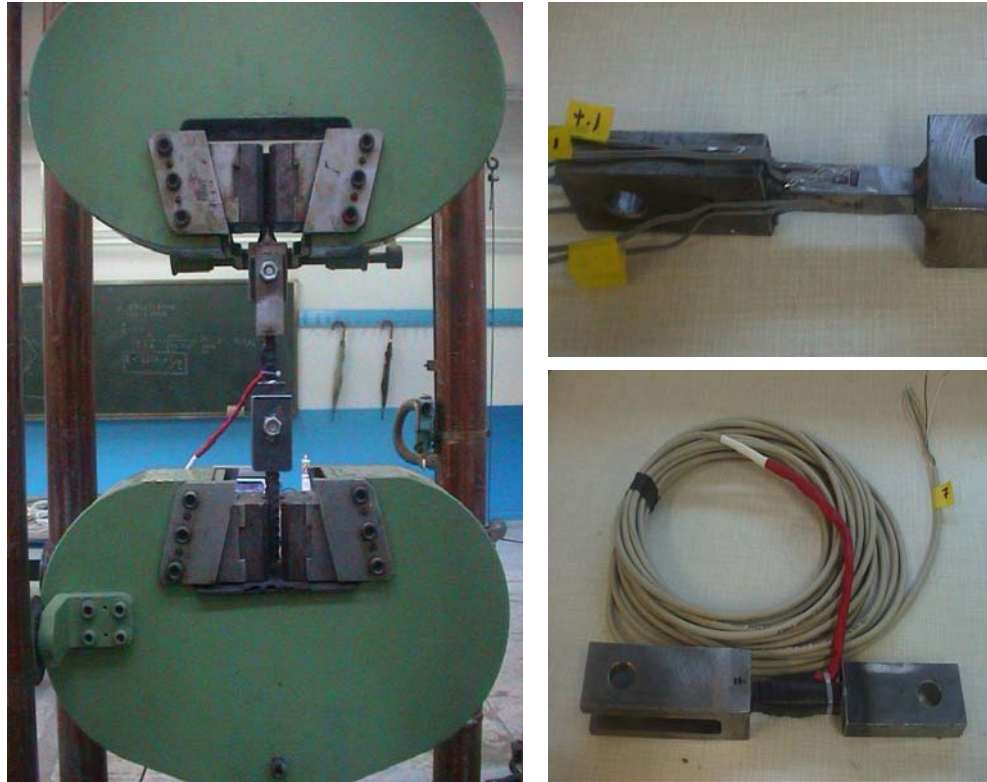
Figura 5-13. Calibración de las bielas y detalle de la instrumentación
