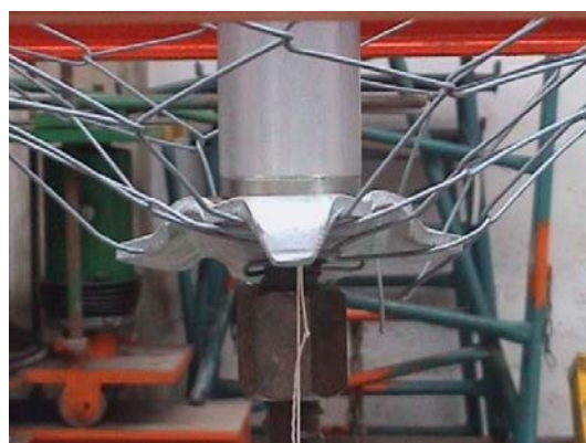
Figura 5-41. Detalle del ensayo de punzonamiento para malla TECCO Mesh G-65
