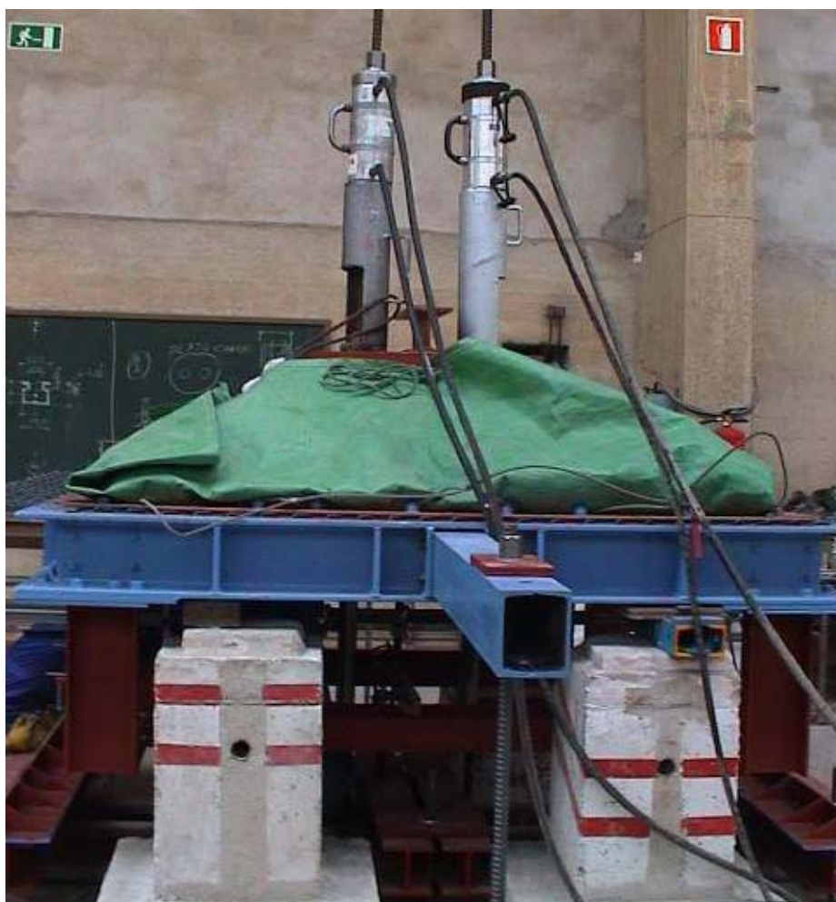
Figura 6-6. Aplicación de la carga en el ensayo de carga distribuida “Bidireccional”
