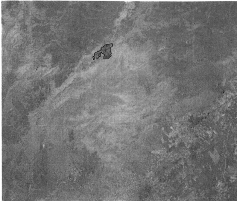
Figura 73. Índice de vegetación ajustado al suelo (SAVI). Imagen Landsat-TM bandas 5 y 7. Sierra Espuña, 4 de julio de 1996 (visualización con 256 niveles de gris)
