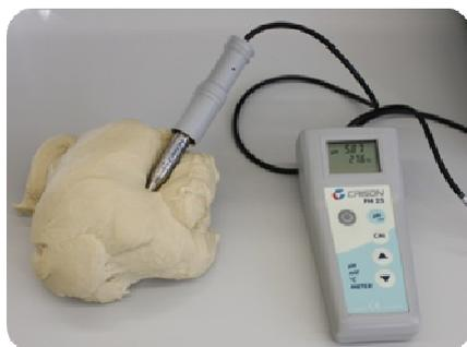
**Figura 8.** Medición de pH de la masa.
