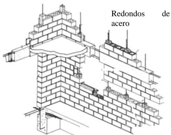
Figura A 7 Ejemplo de obra de mampostería reforzada hecha con bloques de hormigón, que corresponde a un edificio de Chile
