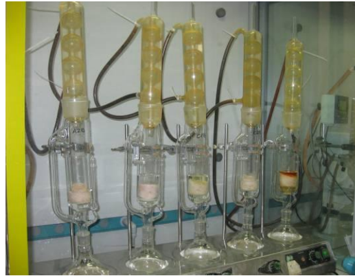
Figura 33. Sistema de extracción Shoxlet
