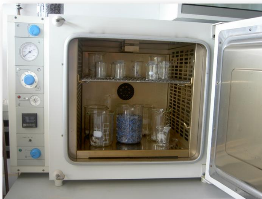
Figura 27. Secado de muestras
