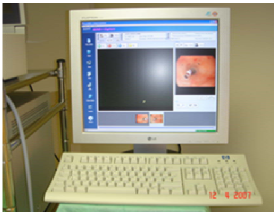
Figura 19: Sistema de registro de imágenes incluye un monitor, una cámara y un sistema de procesador de imágenes
