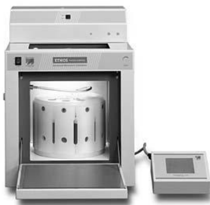
Figura 2.5: Microones emprat en l'extracció d'espècies de Hg.
