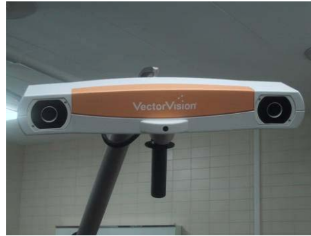
Figura 18: Izquierda: aspecto de la cámara adosada a la estación de trabajo por un brazo articulado Derecha: detalle de las dos cámaras con una distancia entre ellas de 100 cm.
