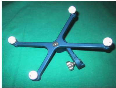
Figura 23: Adaptador en forma de estrella para permitir el reconocimiento y calibración del microscopio y su interconexión al sistema de neuronavegación.
