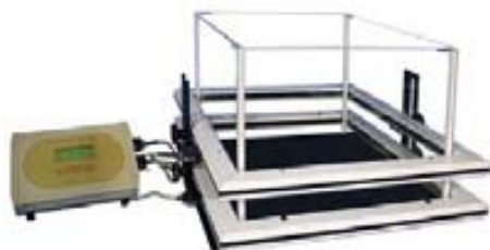
Figura M.7: Sistema Actimeter para medir actividad locomotora espontánea
