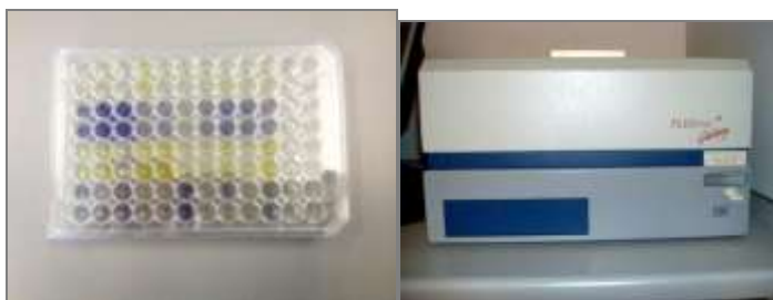
FIGURA 2.2: Placa de 96 pocillos para medir la absorbancia con el espectrofotómetro Multi Skan. (MCC/340P).
