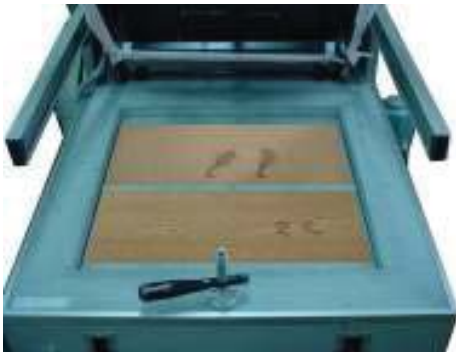
Figura 13.8 Máquina de termo-formado
