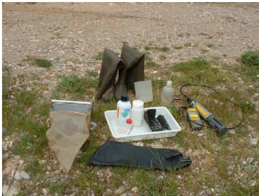
Figura 2.1. Material emprat pel mostreig dels macroinvertebrats fluvials i mesures a fetes in situ de paràmetres físics i químics.
