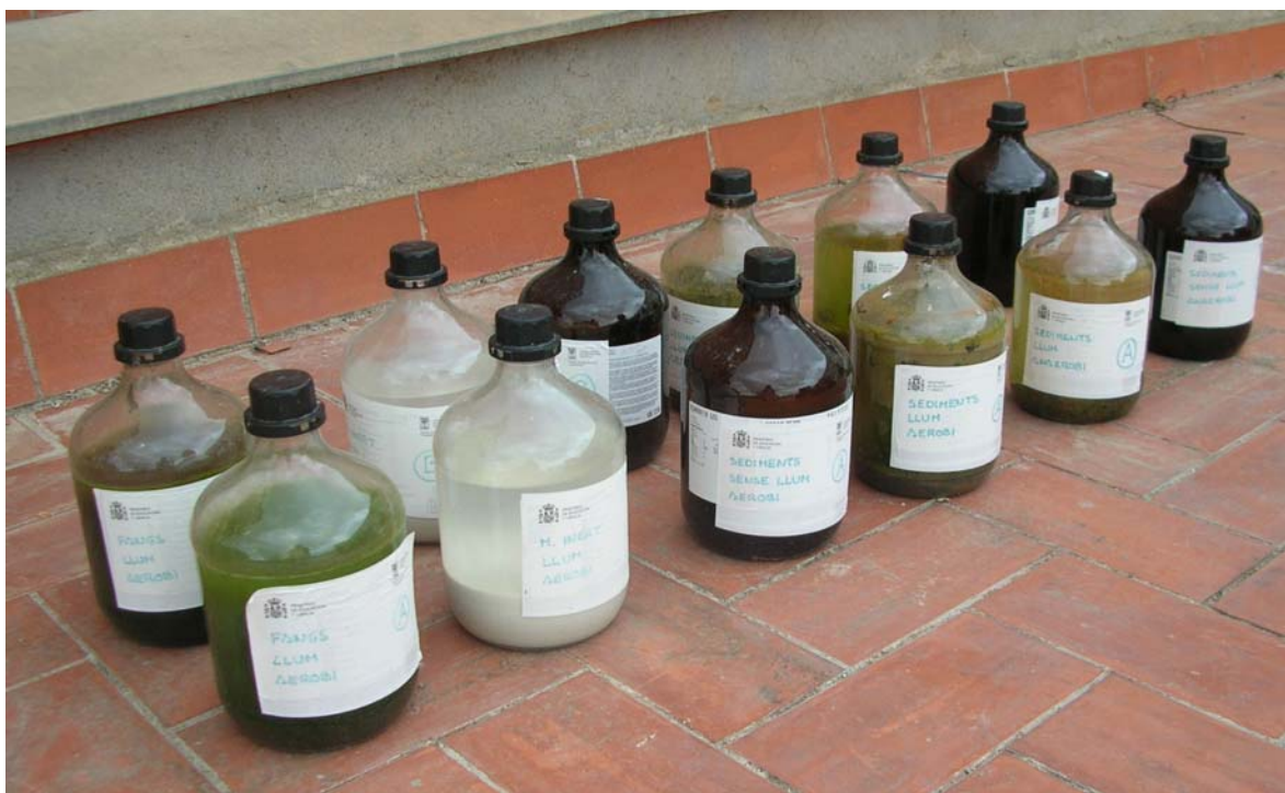
Figura 5.1: Disposició de les ampolles per a l'experiment de degradació a condicions ambientals a l'exterior dels laboratoris
