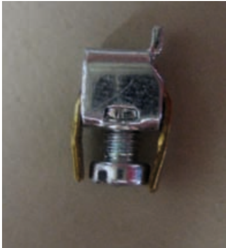
Figura 48 Detalle de la prensa que permitía una fijación de las suturas para no perder la tensión debido a la fragilidad de la elasticidad observada con el anudado
