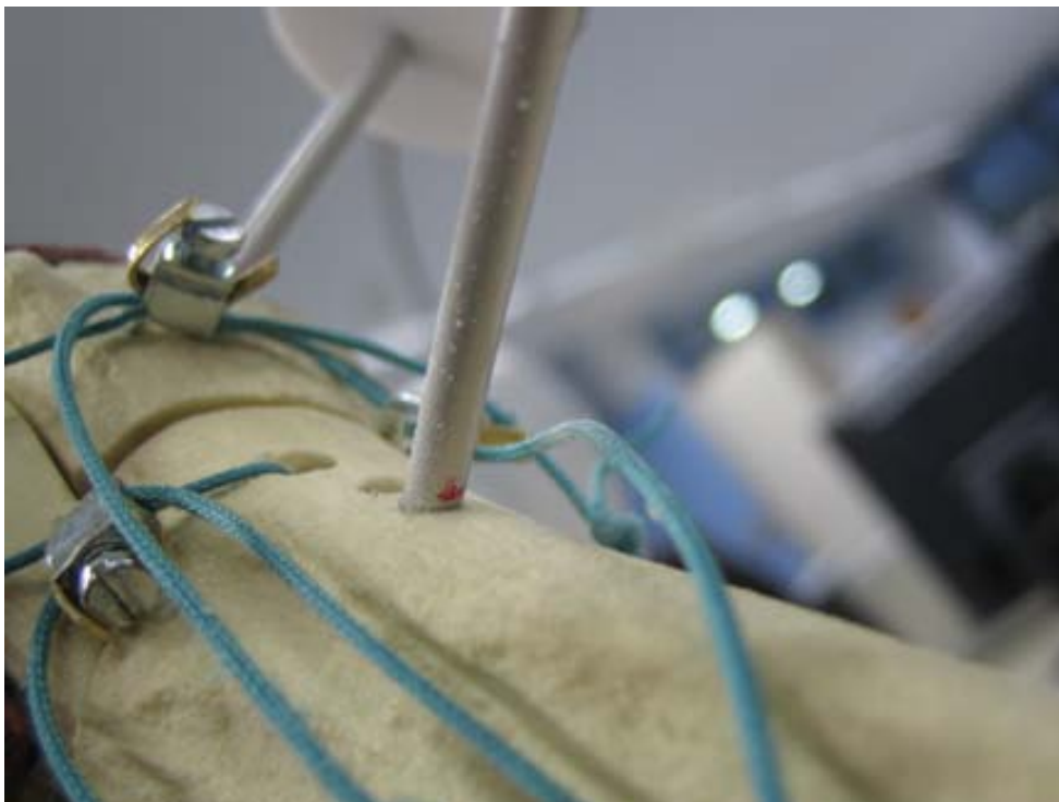
Figura 47 Detalle de la señal de profundidad de los pins que sostienen los sensores electromagnéticos para medir el desplazamiento de los fragmentos que componen la fractura proximal de húmero
