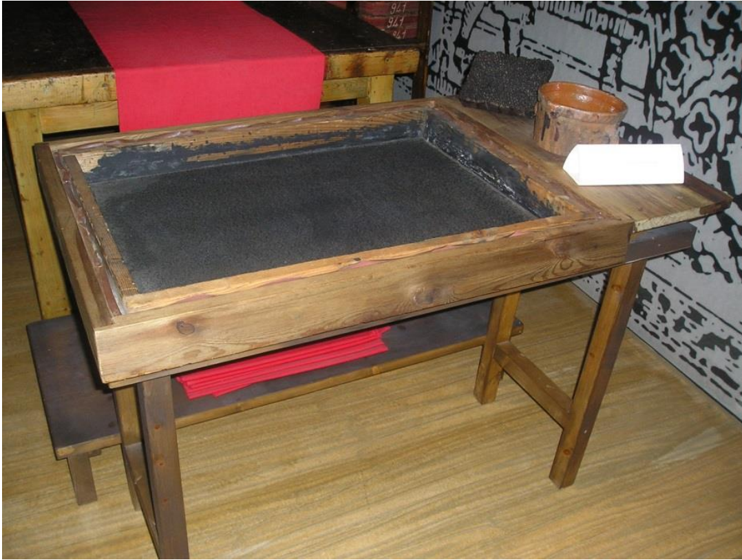
Figura 3. Bach o cubeta para remover la pintura. Museo de la Estampación. Premià.
