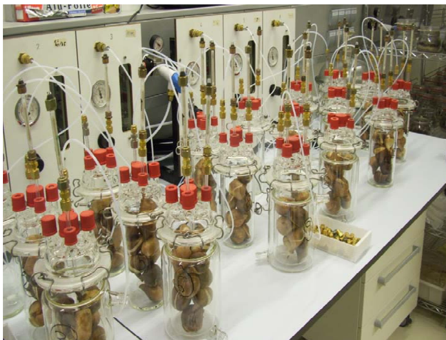
Figura 7. Montaje del sistema de extracción por purga y trampa
