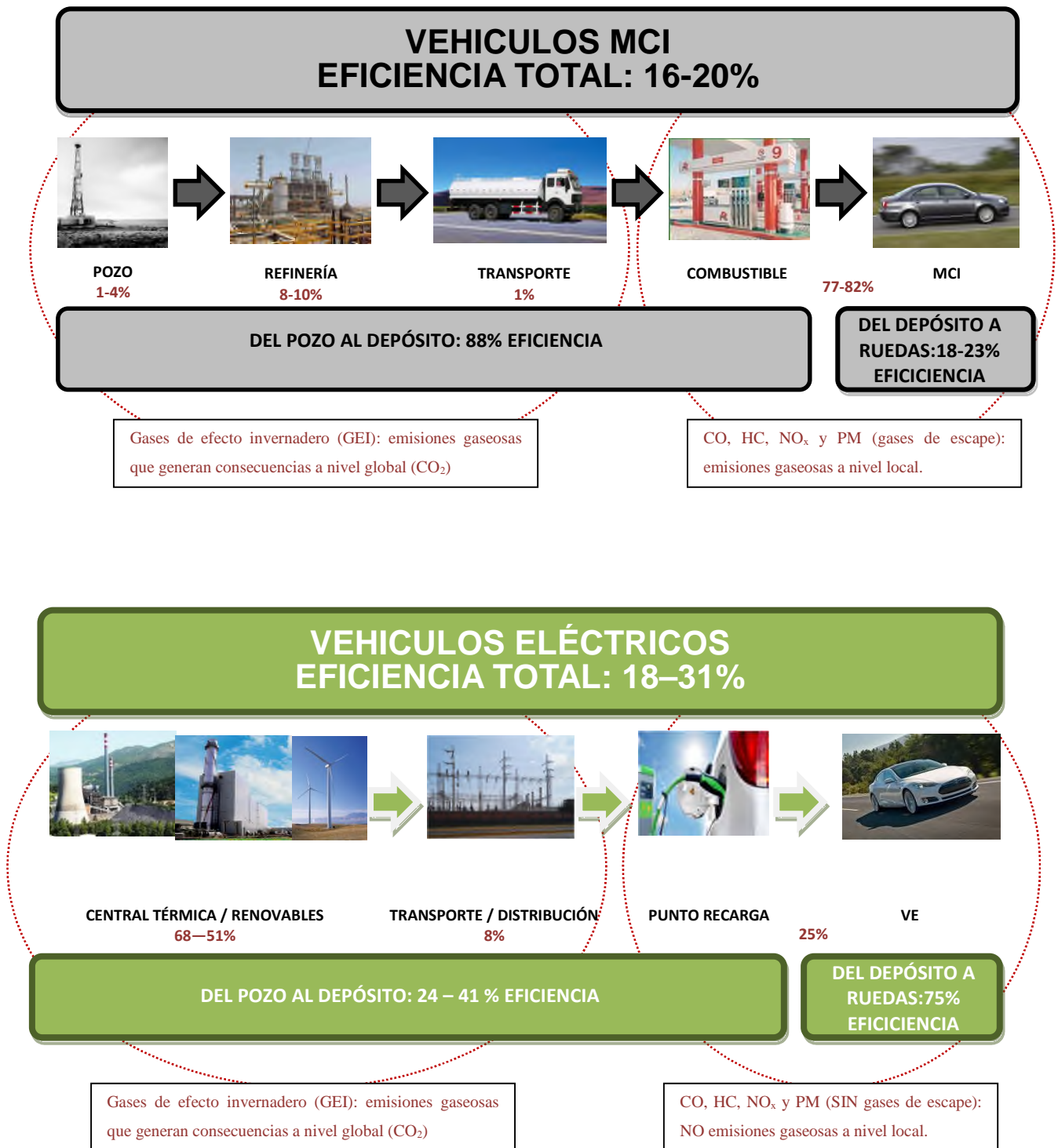
Gráfico 44. Eficiencia y Pérdidas de un vehículo de combustión interna (MCI) frente a un vehículo eléctrico (VE). Elaboración propia.
