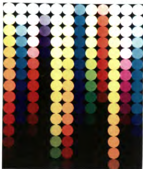
Figura 4.26: Mostres de color extrems d'imatges de la Macbeth COLOR-CHEKER variant la intensitat de l'illuminant.
