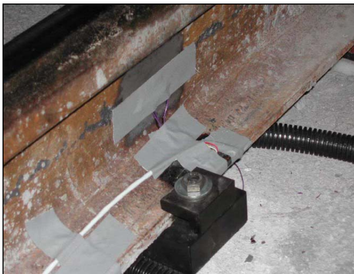
Figura 2.16. Disposición del acelerómetro debajo del carril y del sensor extensiométrico en el alma del carril.
