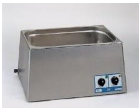
Figura 7. Ultrasonido utilizado en la preparación de materiales
