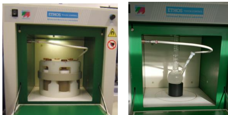
Figura 8. Montaje microondas en autoclave y reflujo utilizado en el tratamiento hidrotérmico de las muestras.
