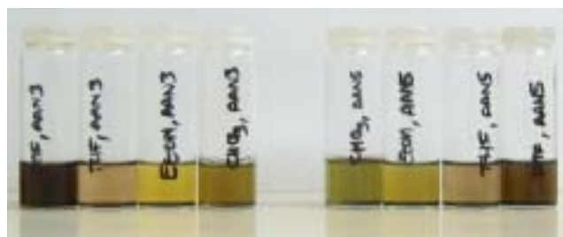
Figura 11.13. Dissolucions estables de nt3aan3 i nt3aan5 en DMF, THF, EtOH i \text{CHCl}_3 .
