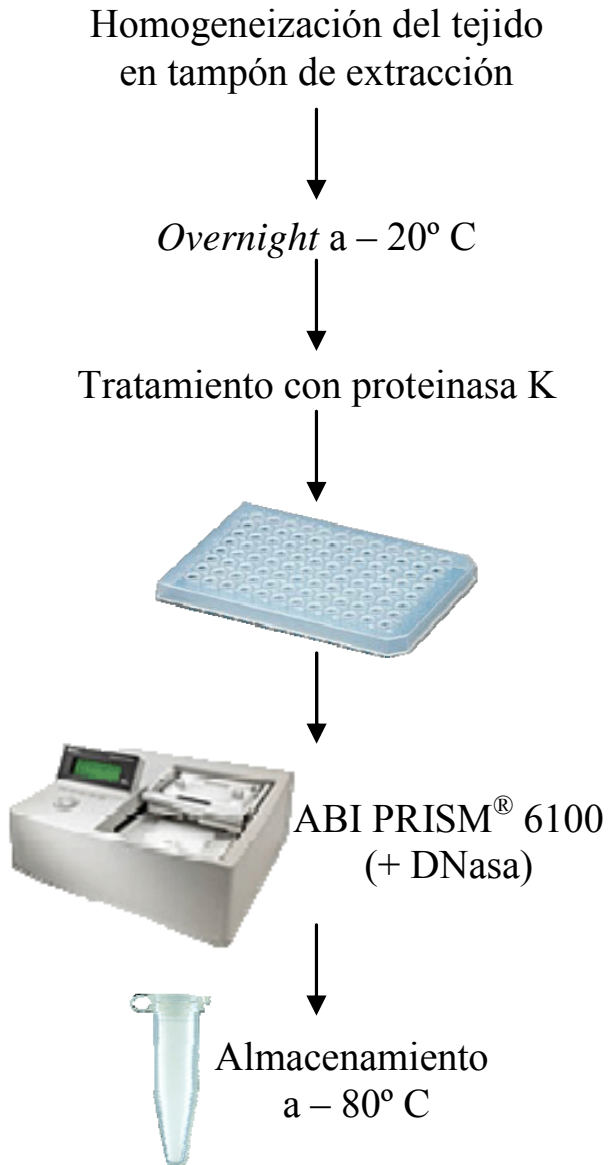
Figura 4.1. Esquema de los principales pasos de la extracción de ARN mediante el equipo ABI PRISM ® 6100.
