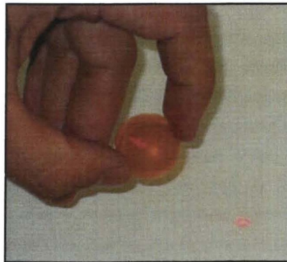
Figura II.2.4. Aerogel de \text{SiO}_2 amb nanopartícules de \gamma\text{-Fe}_2\text{O}_3 travessat per un làser de baixa intensitat.
