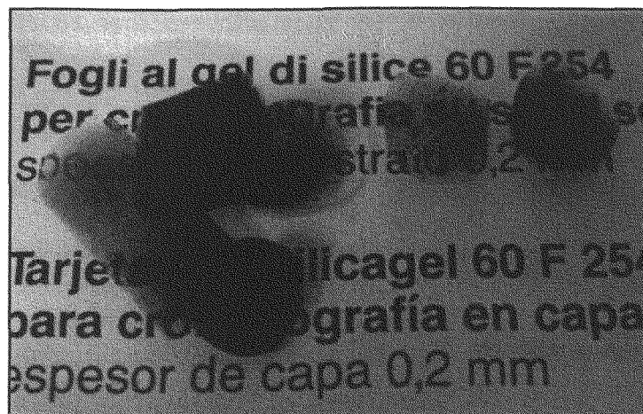
Figura II.1.2. Aerogels de \text{SiO}_2 amb partícules de Nd-Fe-B sintetitzats sota camp magnètic.
