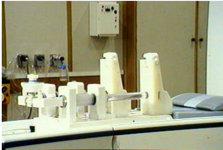
Figura 9 – Vista del ergómetro donde podemos distinguir los pedales y el circuito hidráulico, que está compuesto por dos cilindros con sus respectivos pistones y la válvula que permite el control de la resistencia al pedaleo.
