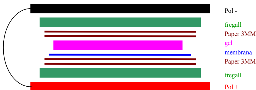
Figura 3.5. Esquema de la transferència de proteïnes.
