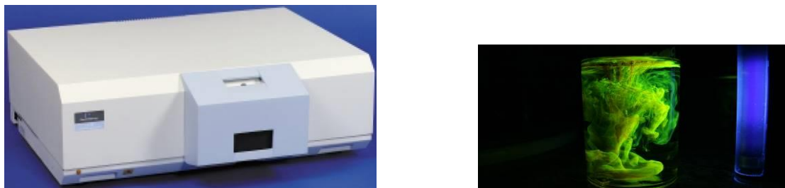
Figura 3.6 Fluorímetro Perkin Elmer LS55 (izda.) y fluoresceína disolviéndose en agua bajo luz ultravioleta (dcha.) (Briksnite/CC-BY-3.0)
