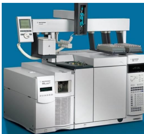
Figura 3.4 Cromatógrafo Agilent GC7890, espectrómetro de masas MS5975 y automuestreador Gerstel MPS-2XT
