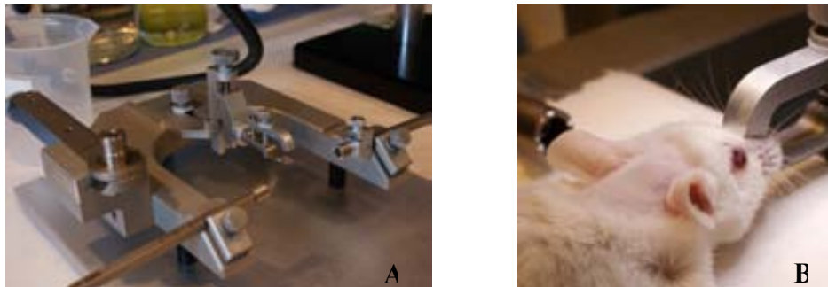
Figura 52: A) Imatge de l'aparell estereotàxic, més concretament de la part on s'immobilitza l'animal. B) Imatge on es mostra la correcta disposició del cap de l'animal, per poder procedir a la cirurgia.
