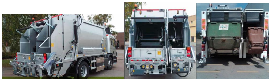
Figura 27 Vehicle bicompartimentat: divisió caixa vertical
