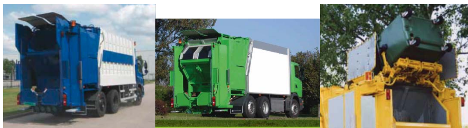
Figura 26 Vehicle bicompartimentat: divisió caixa horitzontal
