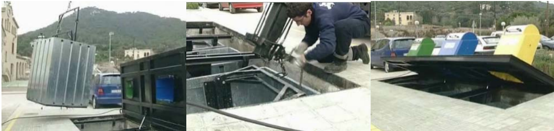
Figura 19 Sistema d'elevació mecànica amb tapa hidràulica
