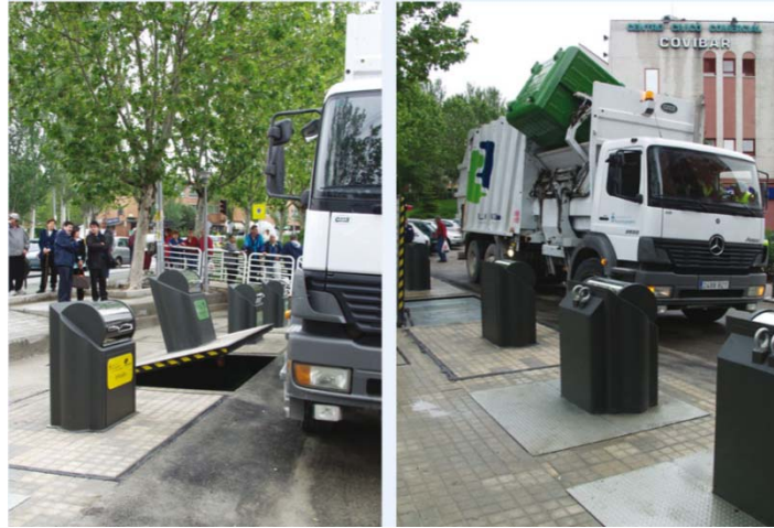
Figura 18 Sistema d'elevació hidràulic. Contenidors càrrega lateral
