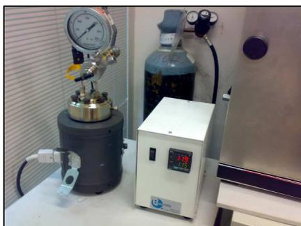
*Figura 3.9. Imagen del dispositivo de crecimiento hidrotermal.*
