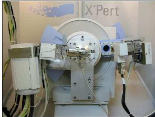
**Figura 2.3.** Goniómetro del difractómetro PANalytical X'Pert Pro MPD Alpha-1  $\theta/\theta$ , con la configuración óptica paralela con monocromador híbrido y portamuestra con capilar en rotación.
