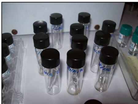
**Figura 3.8.** Imagen del dispositivo de cristalización con “inserto”.
