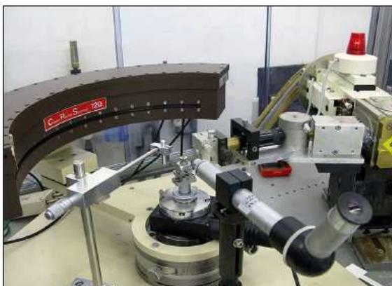
**Figura 2.4.** Difractómetro Inel.
