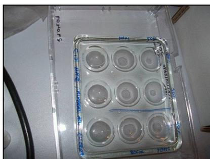
**Figura.3.3.** Dispositivo de cristalización por disolución-evaporación del  $C_{13}H_{24}O_4$  utilizando aceite mineral.
