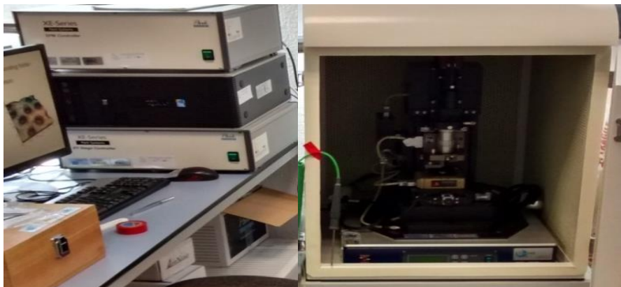
Figura 3.11. Microscopio de fuerza atómica (AFM) utilizado en este trabajo
