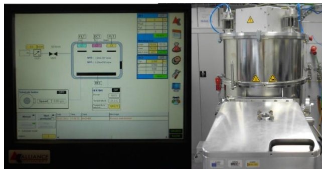
Figura 3.2. Equipo de sputtering utilizado para el depósito de capas de molibdeno
