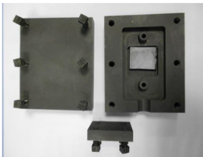
Figura 3.5. Caja de grafito utilizada para procesos de selenización
