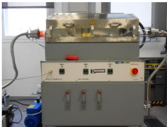
Figura 3.4. Vista frontal del horno tubular empleado para la síntesis de los absorbedores de \text{Cu}_2\text{ZnSnSe}_4
