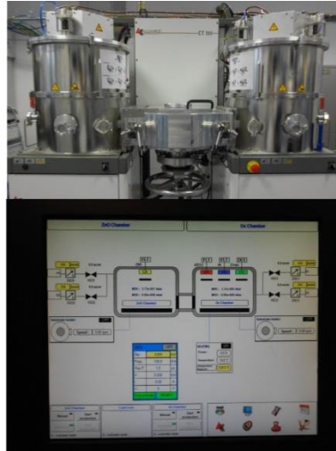
Figura 3.8. Sistema de sputtering para el depósito de óxidos conductores transparentes i-ZnO/ITO
