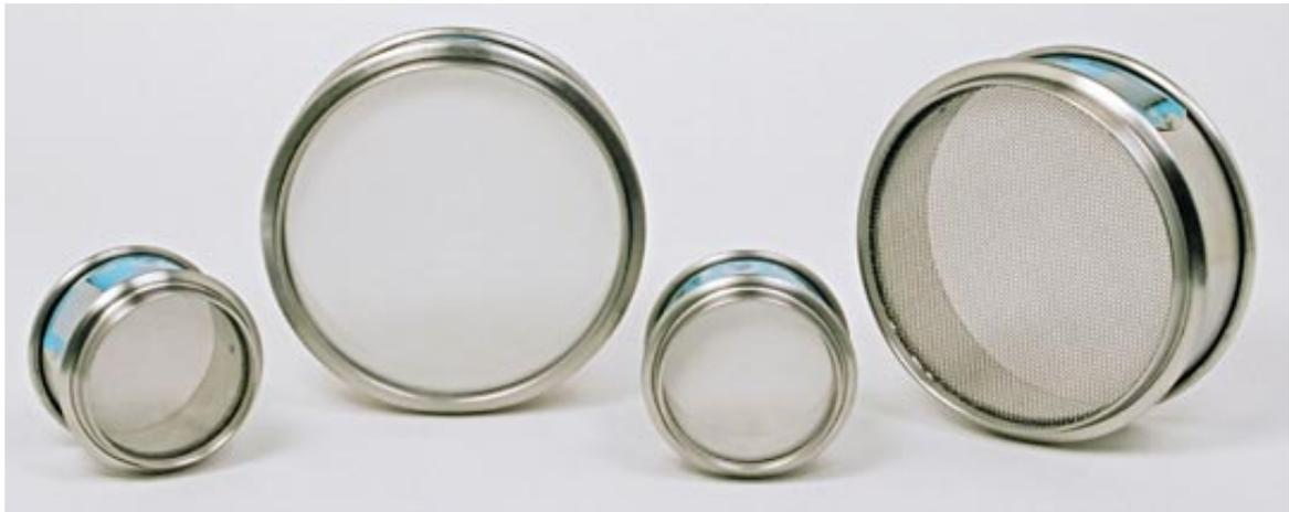
**Figura 37. Tamices normalizados para el control del residuo de las arcillas.**
