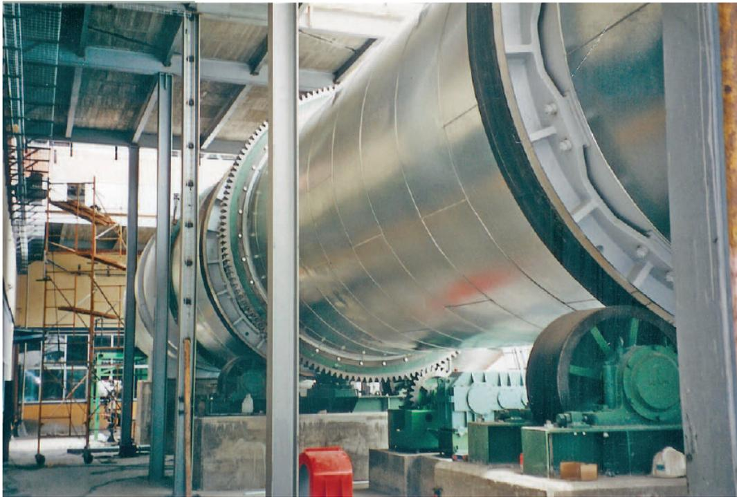
**Figura 20. Horno rotatorio para el tratamiento térmico de los minerales.**
