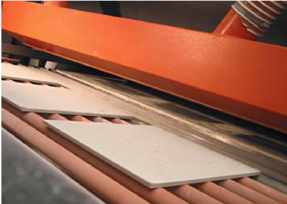
**Figura 2. Baldosas cerámicas a la salida de la prensa industrial.**
