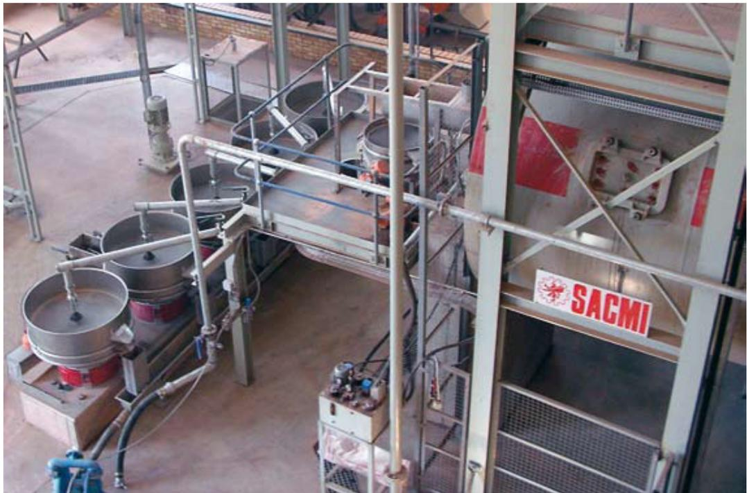
Figura 6. Batería de tamices a la salida del molino continuo.
