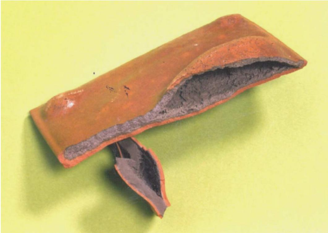
**Figura 19. Pieza esmaltada con presencia de "corazón negro" y abultamiento en la misma pieza.**
