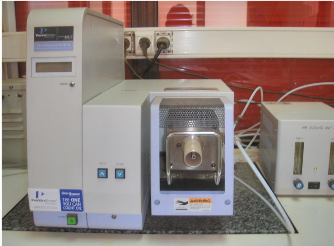
Figura 28. Equipo de análisis térmico, (ATD/TG).
