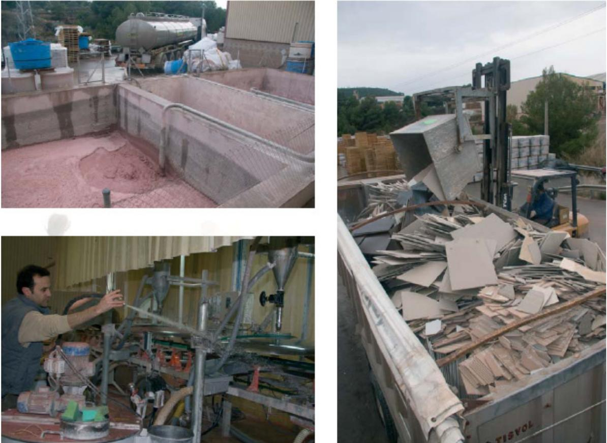
Figura 23. Distintos residuos generados en el proceso de producción cerámica: lodos, aguas sucias procedentes de la limpieza y tiestos crudos y cocidos.
