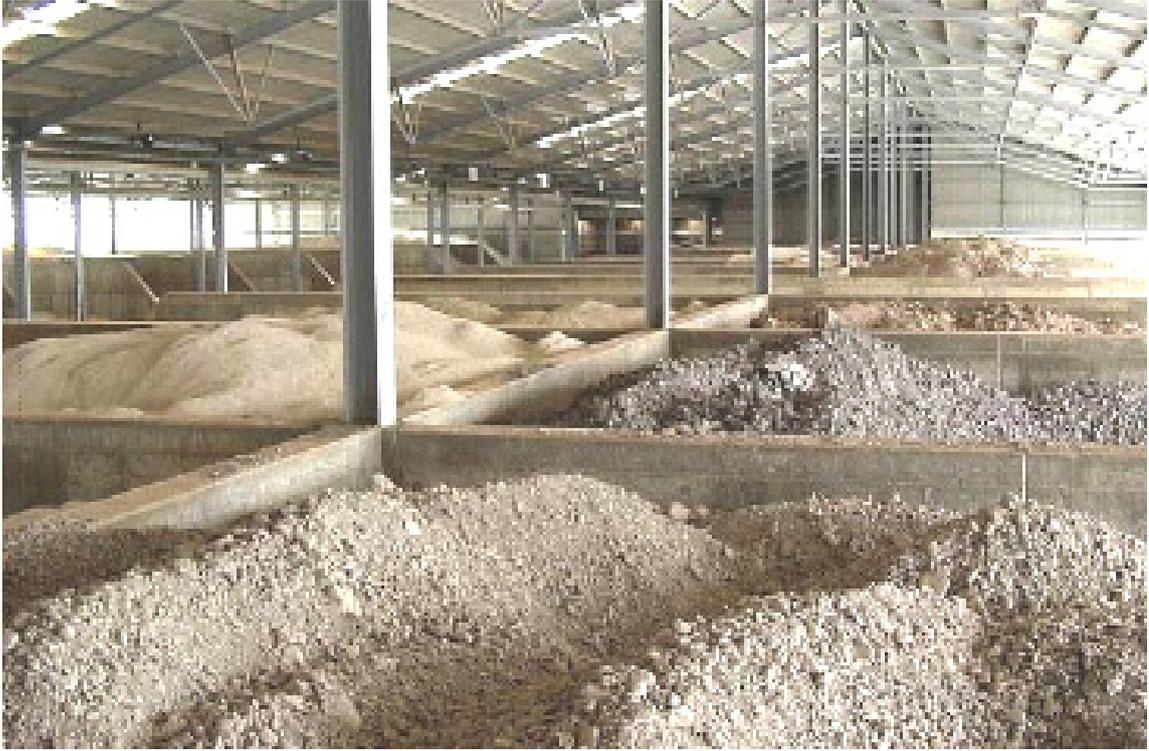
**Figura 13.** Disposición de un almacén de materias primas ("granero") de una empresa atomizadora de arcillas.
