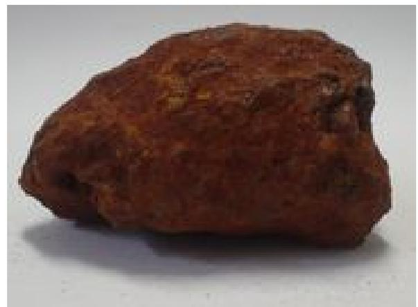
**Figura 16. Imagen de los compuestos de hierro: siderita y hematita.**
