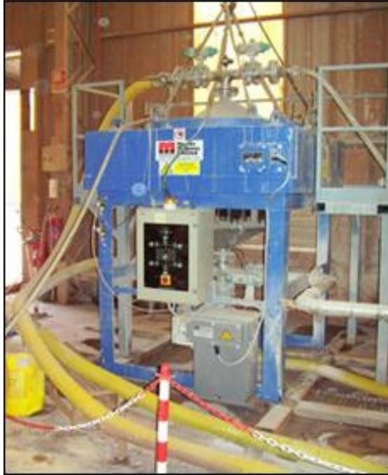
**Figura 47. Filtro electromagnético industrial de Master Magnets adquirido por Tierra Atomizada y utilizado en la presente Tesis.**
