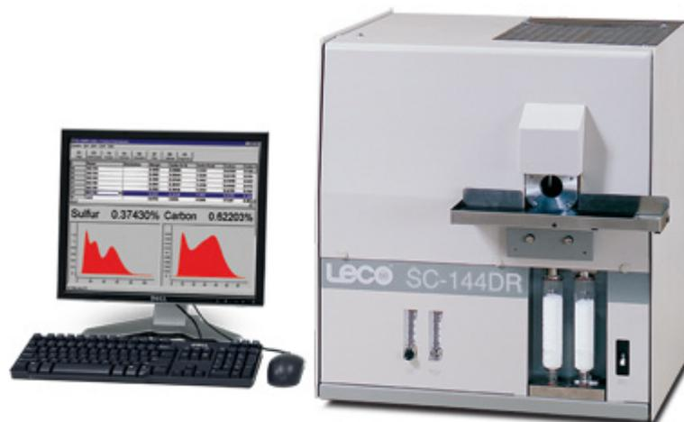
Figura 33. Analizador de carbono y azufre.
