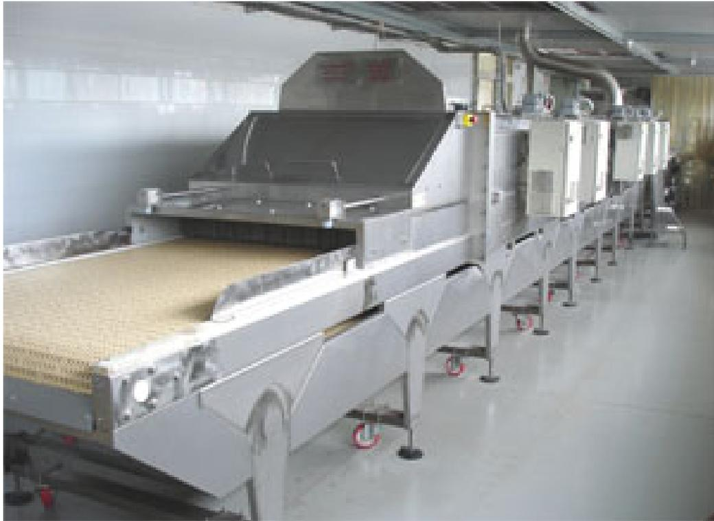
**Figura 22. Horno microondas industrial.**
