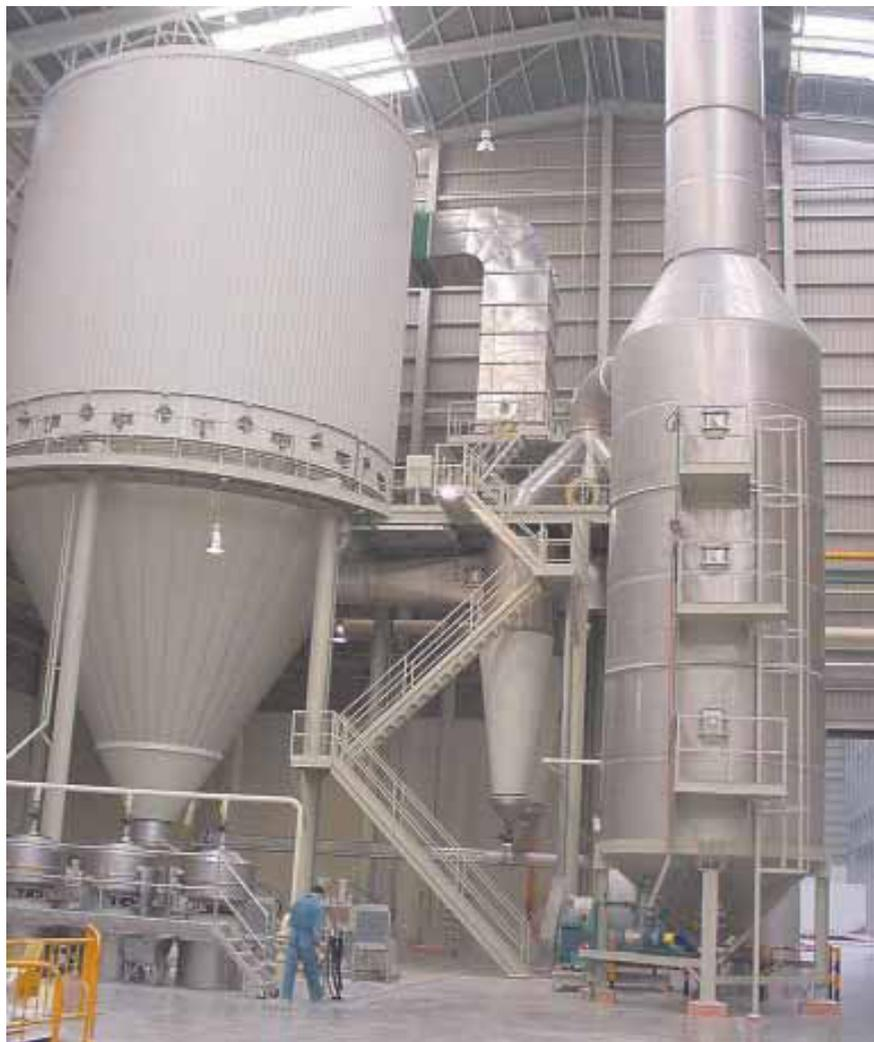
**Figura 11. Instalación de un atomizador industrial.**
