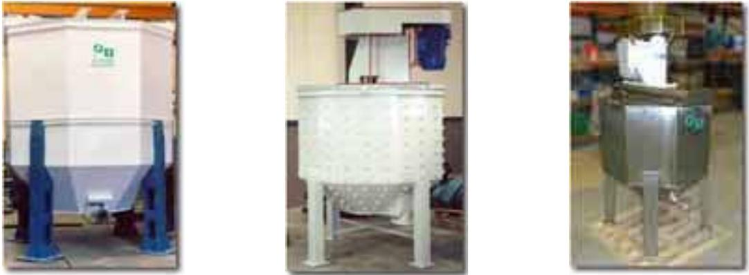
Figura 4. Varios modelos de "turbodesleidores".
