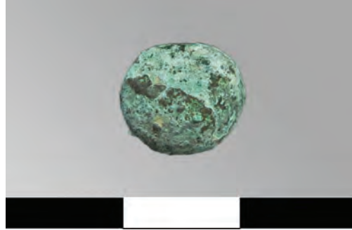
Figura 5.13. Nódulo de cobre procedente de Agua Amarga. Este tipo de nódulos se quedan atrapados entre la escoria.
