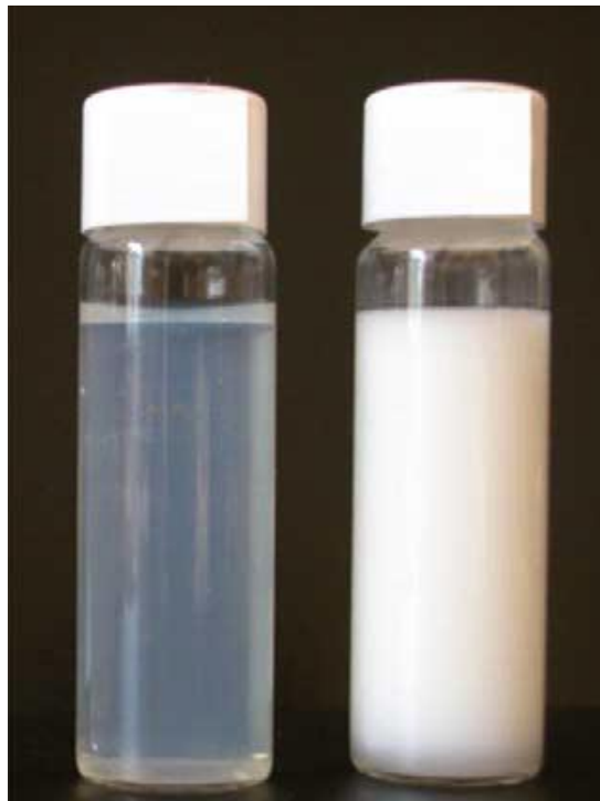
Figura 1.15. Aspecto de una nano-emulsión (izquierda) y una macro-emulsión (derecha), con diámetros de gota de 35 nm y 1 \mu m, respectivamente (Solans, 2005).
