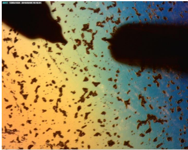
Fig.5. En la imagen se puede observar cómo se han dispersado las micropartículas de aluminio sobre el sustrato de mica.
