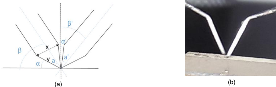
Fig.5. (a) Representación esquemática de la geometría que deben tener las puntas de tungsteno para que además de permitirse la interacción exclusivamente de la punta con la muestra, también permita observar dónde se posicionan éstas, (b) una imagen de cómo finalmente se disponen estas sondas sobre la muestra.
