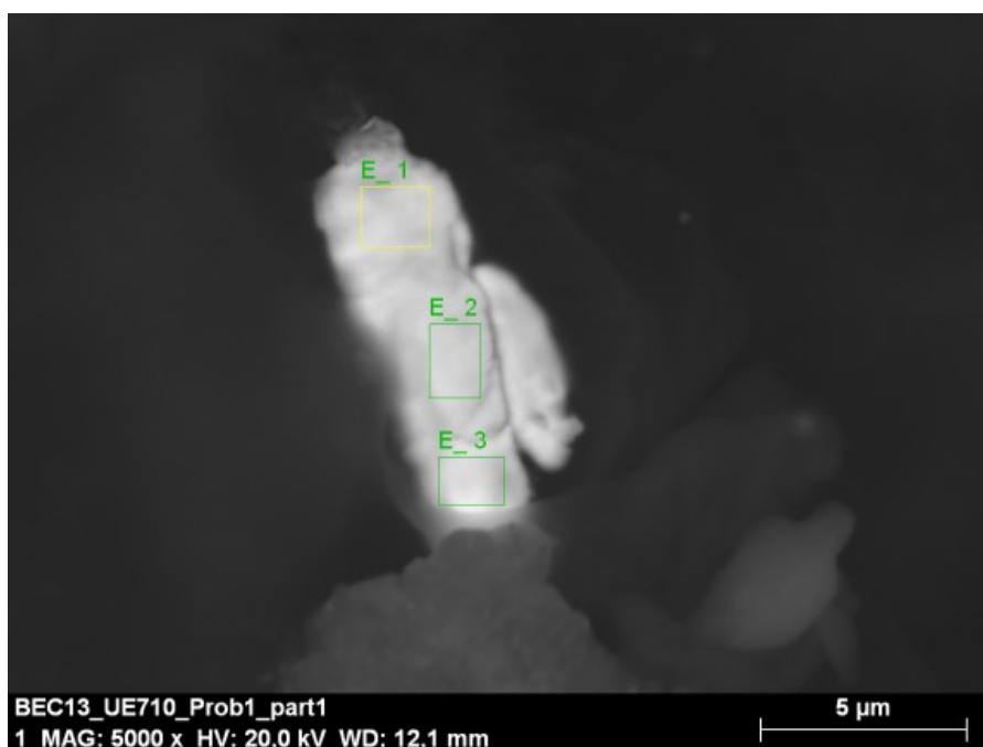
Espectrometria i imatge de la partícula d'or treballat, recuperada d'un gresol del taller metal·lúrgic (GARCIA, 2014)
