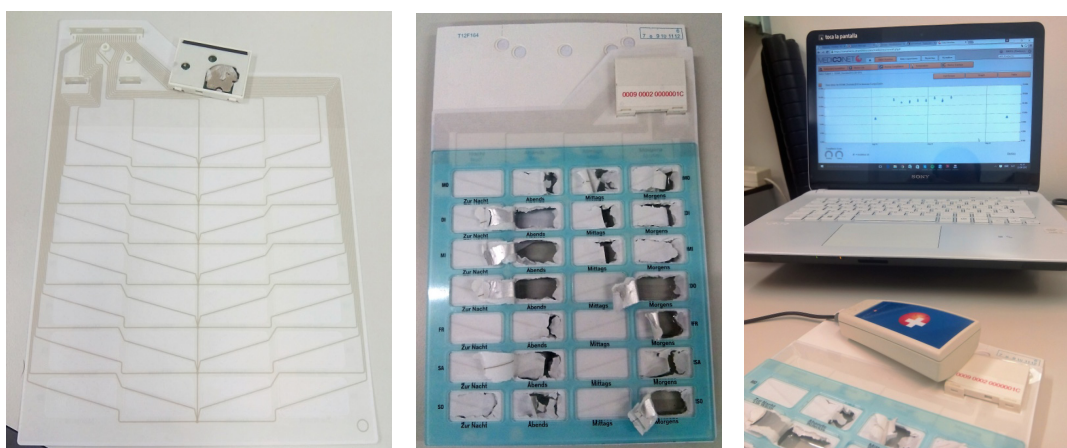
Figura 7: Ejemplo de sistema electrónico para monitorizar la adherencia con SPD de tipo blíster.
