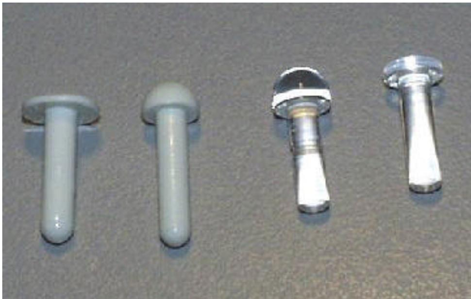
9-3 (A) Juego de vástagos en policarbonato (blanco) y PMMA (transparente). (B) Vástago de polocarbonato encajado en el orificio del implante.
