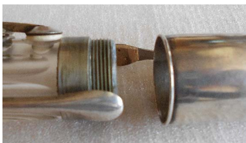
Fig. 7.5. Encaix del cossos superior i inferior per mitjà d'una rosca.
