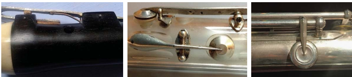
Fig. 3.37 a, b i c. A l'esquerra, sistema de blocs de fusta per fixar les claus. Al centre, claus muntades amb el sistema de platines de Laurent (ex. MG:Lau1839.01). A la dreta, fixació del mecanisme de la flauta actual.
