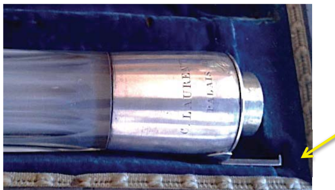
Fig. 7.16. Detall de l'encaix de la baioneta dins l'estoig.
