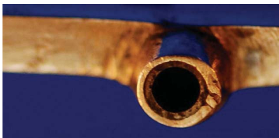
Fig. 3.46. Doble recobriment de l'interior dels eixos de les claus. Exemplar MG:Lau1809.11.
