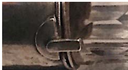
Fig. 3.26. Detall de la petita baioneta entre el cos superior i el cos inferior. Exemplar MG:Lau1814.04.
