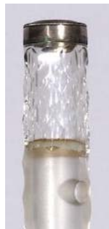
Fig. 3.22. Ex. MG:Lau1818.01 amb el disc de vidre en lloc del suro.
