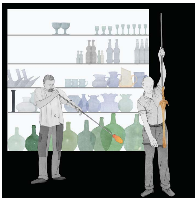
Fig. 3.2. Bufament i estiratge del vidre.
