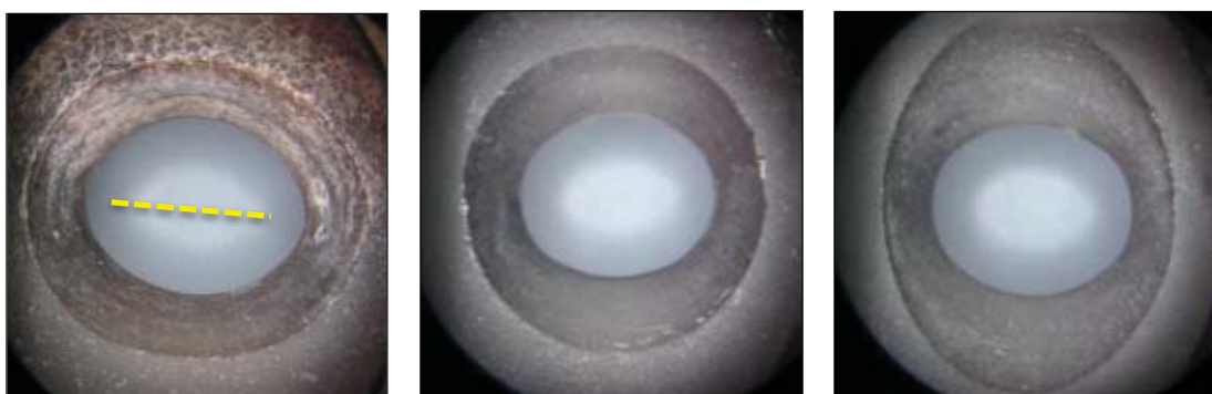
Fig. 3.23. D'esquerra a dreta, imatges endoscòpiques de les embocadures dels exemplars MG:Lau1810.01, MG:Lau1813.04, MG:Lau1833.01. A la primera imatge es pot observar la inclinació de la diagonal major de l'orifici.
