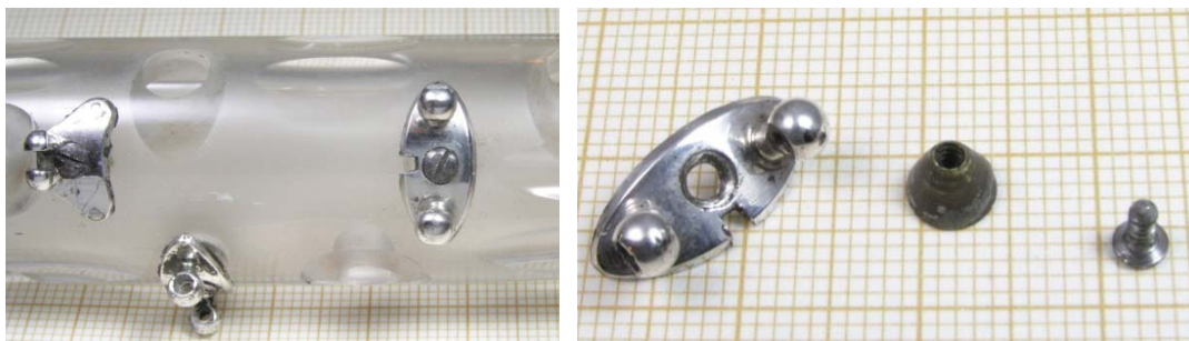
Fig. 3.39 a i b. Imatges de la restauració de l'exemplar MG:Lau1839.01. Museu de la Música de Barcelona. A la dreta, es pot observar les platines fixades al tub. A l'esquerra, una de les platines amb els pilars, el vis i la femella cònica que el fixarà a l'interior del tub.
