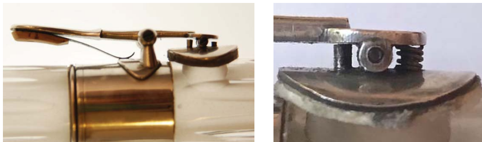
Fig. 3.43. a i b. A l'esquerra clau basculant de re# de l'exemplar MG:Lau1809.11. A la dreta, detall del sistema de basculació de l'exemplar MG:Lau1823.01.
