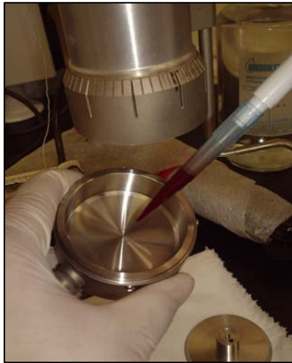
Fig. 22. Receptacle per a la mostra de fluid a analitzar.
