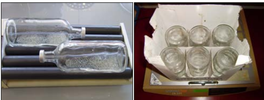
Figura 3.6. Ampolles experimentals de degradació de TCE agitades mitjançant l'agitador tipus roller (esquerra) i agitador orbital (dreta).
