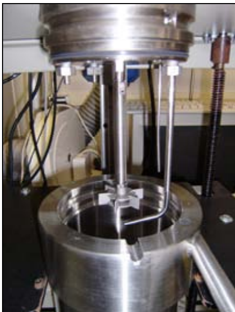
Figura 3.8. Visió detallada dels elements situats a l'interior del reactor. Es pot observar els tubs de buidat (tub en forma de L situat a la dreta) i de presa de mostra del reactor (dreta), i l'agitador mecànic de pales (centre).
