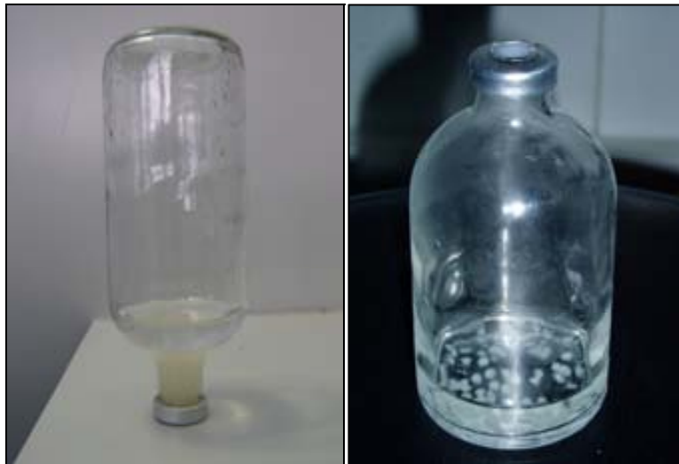
Figura 3.5. Exemple de les ampolles de 500 mL (esquerra) i 125 mL (dreta) utilitzades per a degradar TCE mitjançant T. versicolor .
