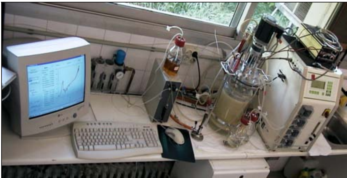
Figura 3.2. Muntatge experimental per determinar el consum d'oxigen de T. versicolor en fermentador.
