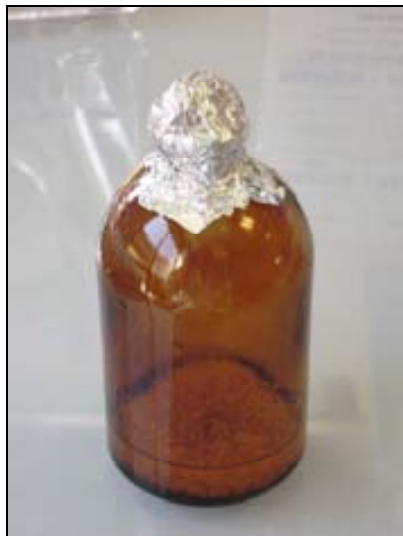
Figura 3.10. Ampolla de sèrum d'un experiment in vivo de degradació de PBDEs mitjançant T. versicolor .
