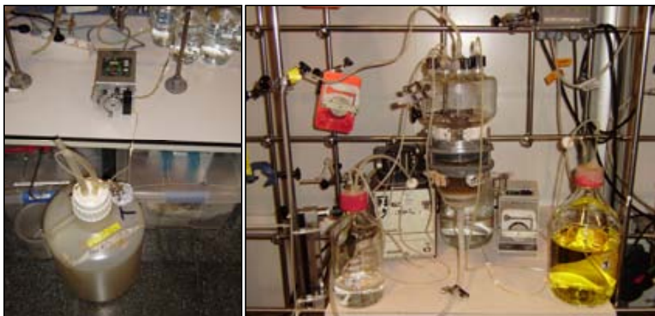
Figura 3.11. Sistema de tractament de carbamazepina en continu mitjançant T. versicolor sota condicions de cicle redox. Muntatge amb el reactor i les ampolles d'aliment de carbamazepina, DBQ i glucosa (dreta) i tanc d'emmagatzemament de l'efluent líquid de sortida del reactor (esquerra).
