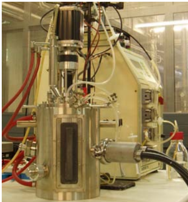
Figura 5.4. Bioreactor de 2 l amb la sonda BioView® connectada via un port lateral especial de 25 mm. A la part frontal de bioreactor hi ha una finestra vertical de quars que permet la visualització del medi de cultiu. La unitat Biostat B es va utilitzar per al control de diferents paràmetres del procés (al fons).
