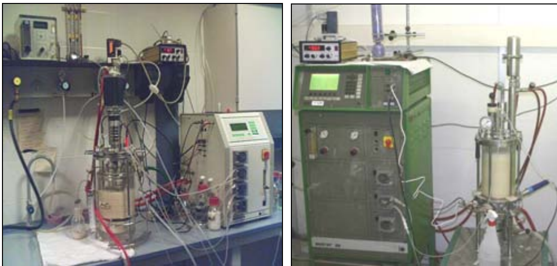
Figura 2.1. Els fermentadors Biostat B (B. Braun, Melsungen, Alemanya) – esquerra- i Biostat ED (B. Braun, Melsungen, Alemanya) – dreta.
