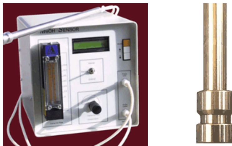
Figura 8.1. Detall del sensor de metanol de Raven Model 2.1 i de la sonda que s'utilitza per a la mesura del metanol al brou de cultiu.
