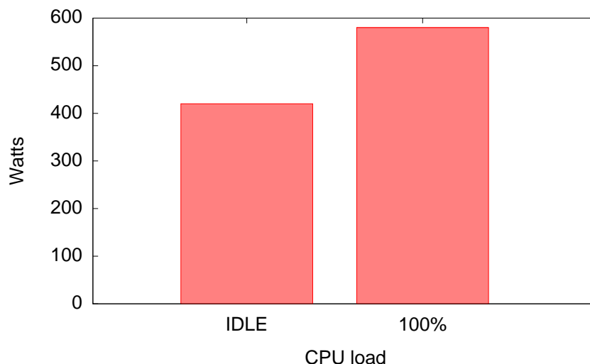
Figura 6.1: Diferencia de consumo eléctrico entre un servidor sin carga y el mismo con carga.
