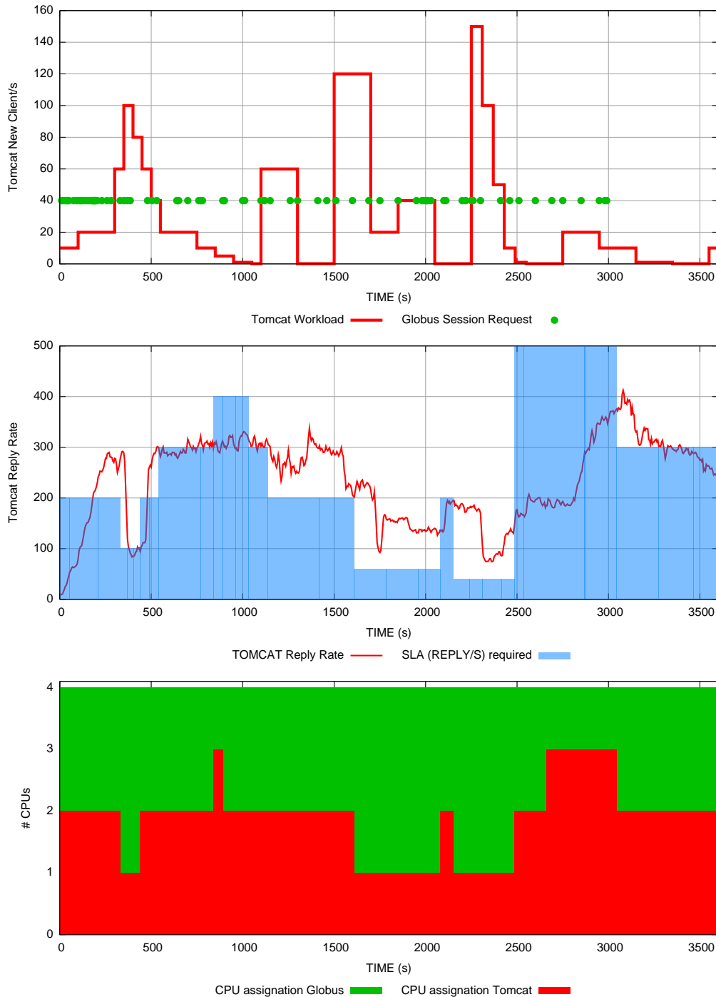
Figura 6.5: Ejecución de un entorno heterogéneo con un gestor de recursos utilizando predicción.
