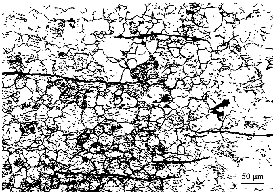
Fig. 5.15. Microestructura final de una probeta de la serie de ensayos M1200 deformada a T = 1100\text{ }^{\circ}\text{C} y \dot{\epsilon} = 0.3\text{ s}^{-1}
