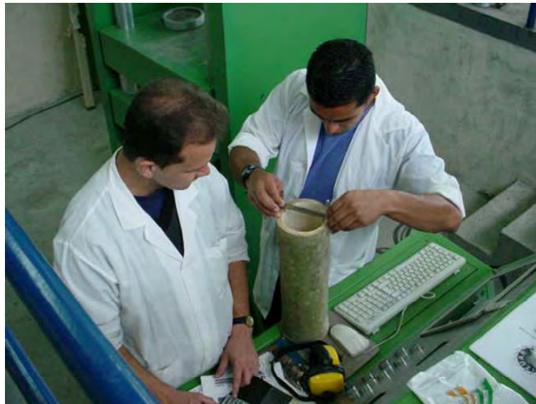
4. Pruebas de laboratorio medición de un tipo de guadua
