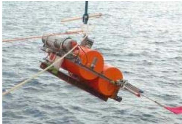
Figura 2.26: Imagen del sismómetro marino K/MT 562 de Geomar
