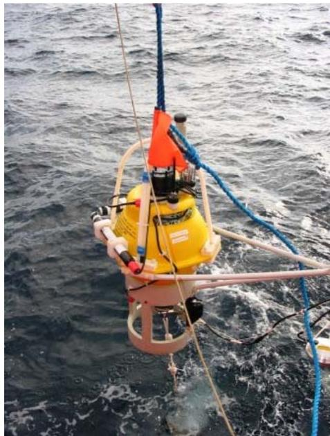
Figura 6.1: Lanzamiento del sismómetro de fondo marino de UPC-UTM en la campaña CALIBRA
