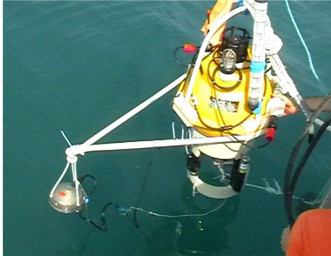
Figura 2.31: Estructura del Sismómetro marino SARTI-UTM
