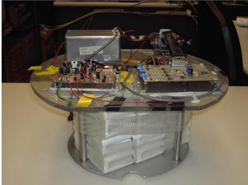
Figura 3.41: Sistema de registro y almacenamiento de datos final
