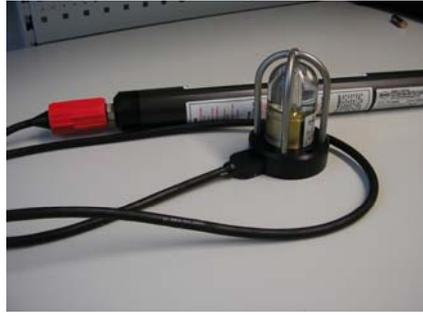
Figura 2.37: Sistema de iluminación xenón
