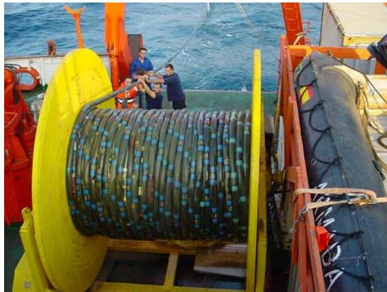
Figura 2.2: Una imagen del streamer
