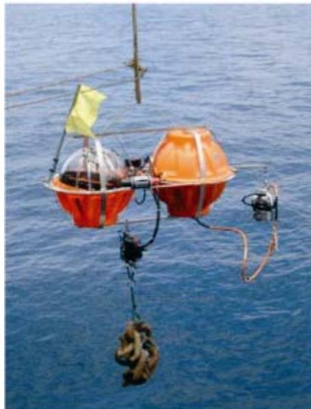
Figura 2.28: Sismómetro de fondo marino Hippocampe de IRD-Geoazur
