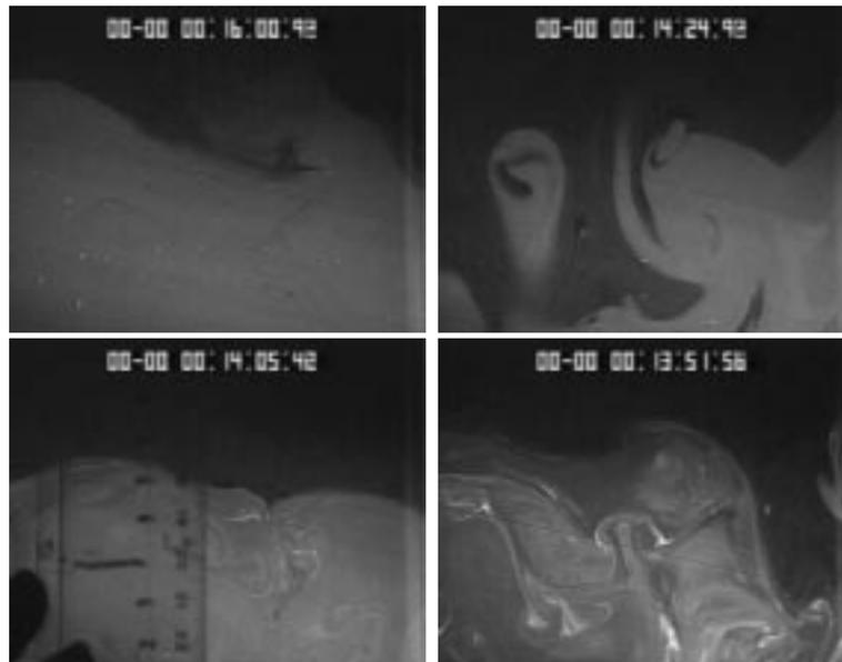
Figura 4.5: Algunos ejemplos de entrañamiento de una interface turbulenta, se observan procesos de engolfamiento en la imagen con  $t=14:24$ , mientras que se puede observar rotura de una onda interna en la imagen  $t=16:00$ .
