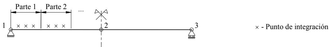
Figura 5.9 – Esquema de la viga para el análisis numérico
